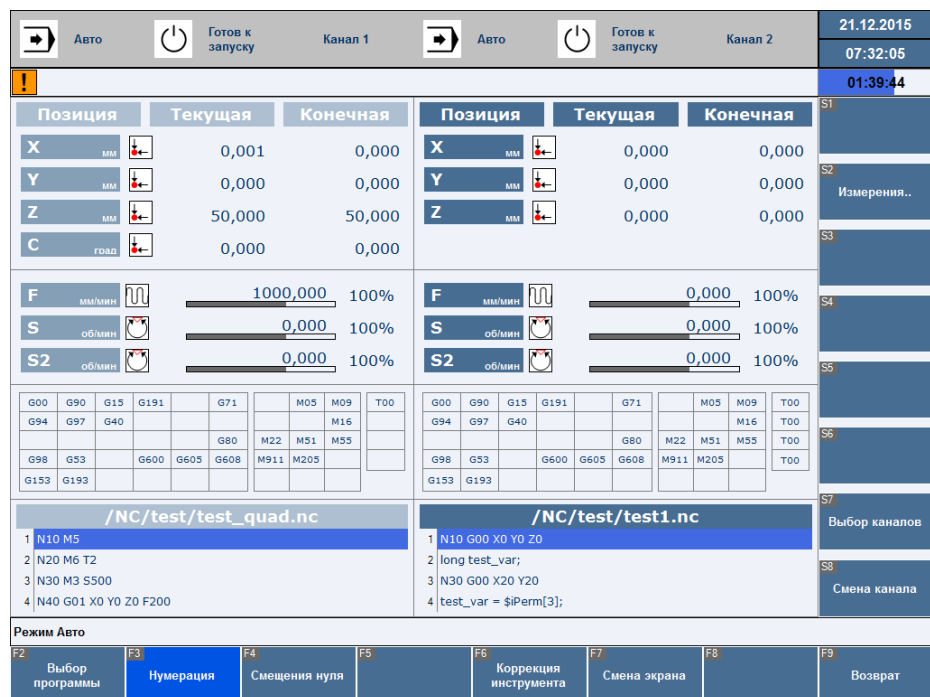
Рисунок 35 – Отображение информации о двух выбранных каналах
