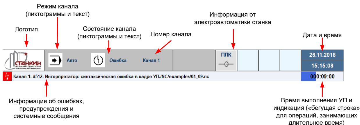
Рисунок 11 – Информация, отображаемая в строке состояния экрана оператора и верхней информационной строке
