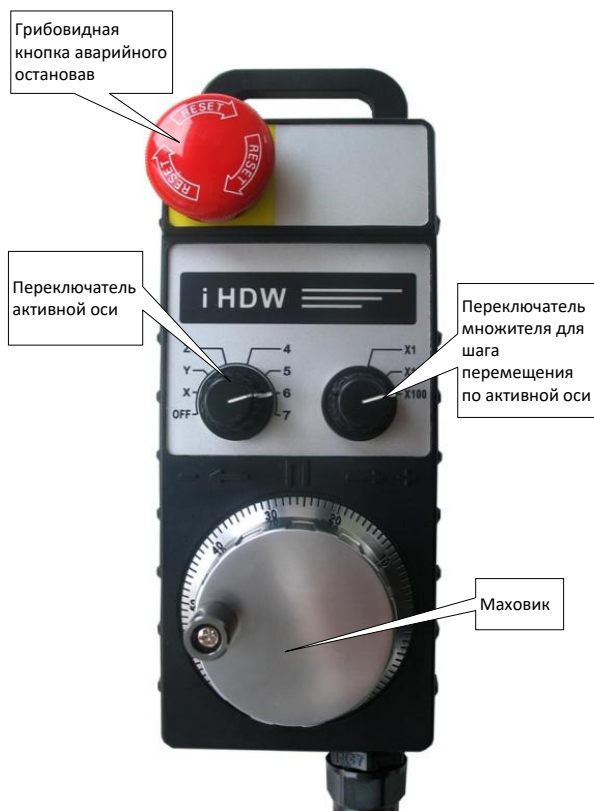
Рисунок 8 – Выносной пульт и его органы управления
