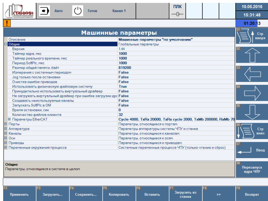
Рисунок 49 – Вид экрана просмотра и редактирования машинных параметров
