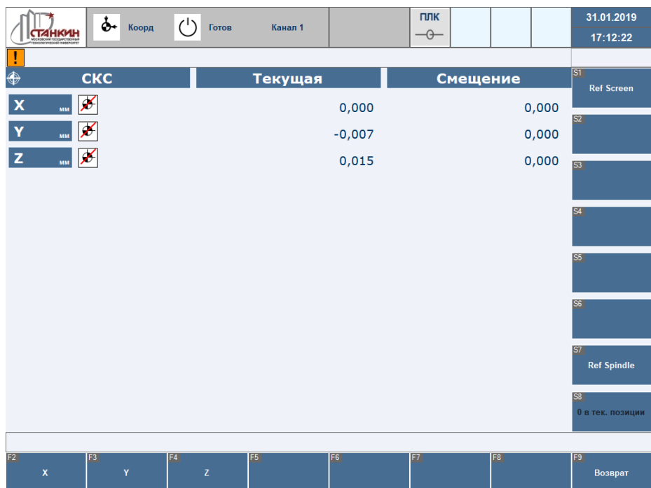
Рисунок 16 – Вид окна экрана оператора в режиме привязки осей
