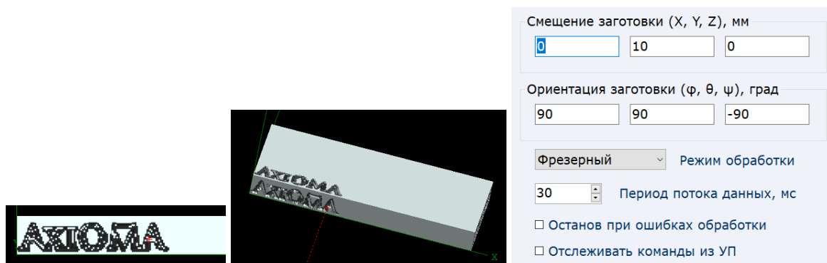
Рисунок 78 – Параметры симуляции и результат выполнения гравировки для поверхности Е
