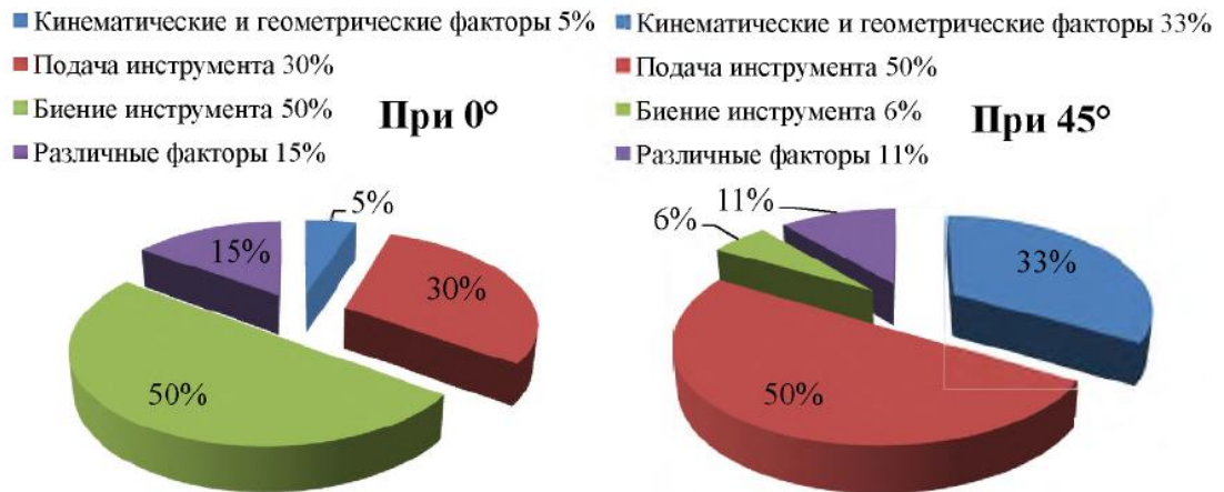
Рисунок 1.9 – Факторы, влияющие на величину шероховатости поверхности с учетом наклона фрезы [37]
