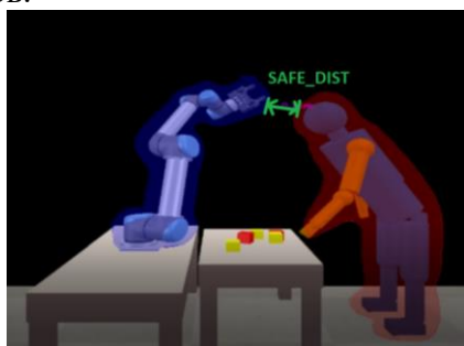
Рис. 1. Ситуация: защитное расстояние безопасно для движений робота
