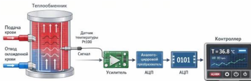
Рис. 1. Структурная схема измерительного канала температуры
