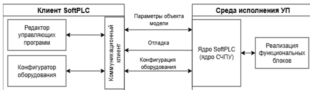
Рис. 1. Обобщённая схема взаимодействия компонентов системы
