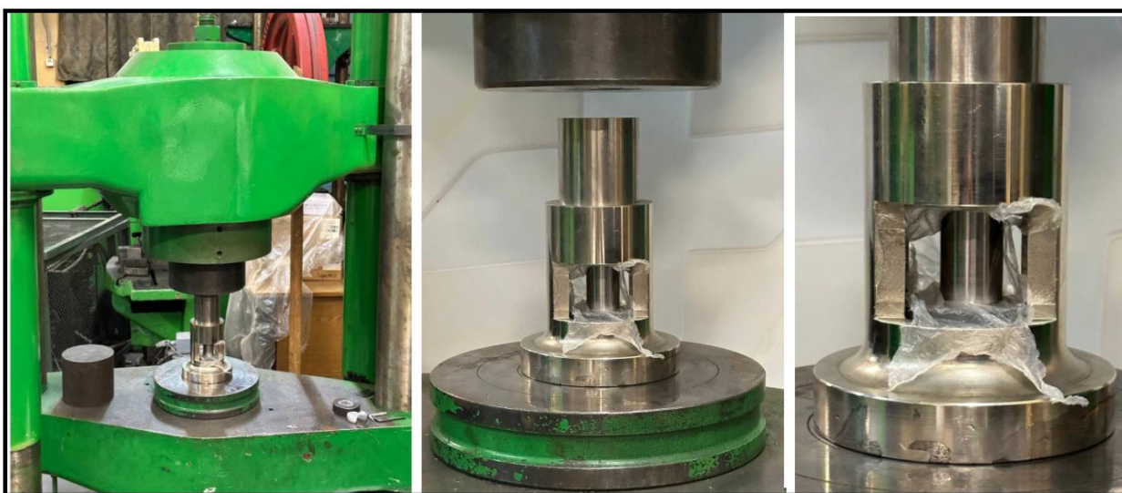
Рисунок 3.1 – Специальная штамповая оснастка типа «стакан» для осадки цилиндрических образцов.
