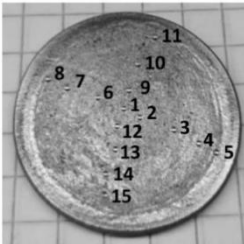
Рисунок 4.2 – Экспериментальные данные измерений величин твердости на торцевой поверхности в местах образцов из стали 20
