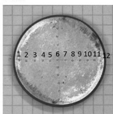
Рисунок 4.1 – Экспериментальные данные измерений величин твердости на торцевой поверхности в местах образцов из стали 10
