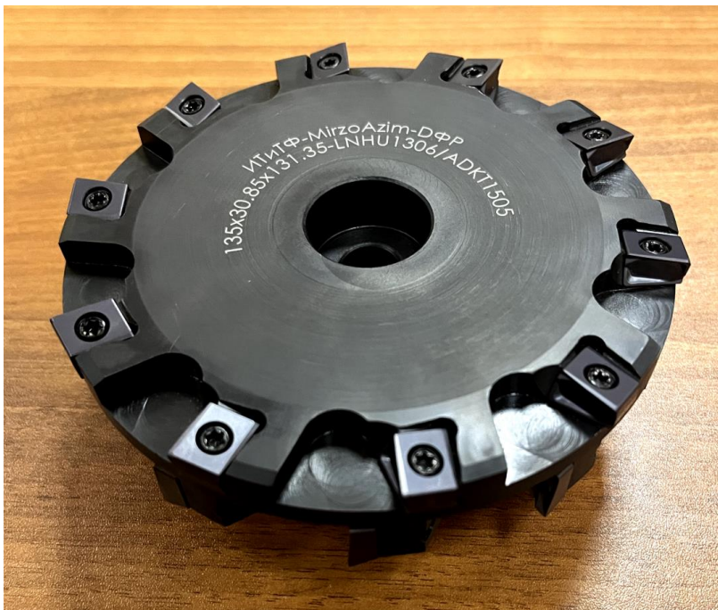
Рис. 3.19 – Опытный образец дисковой фрезы с СМП.
