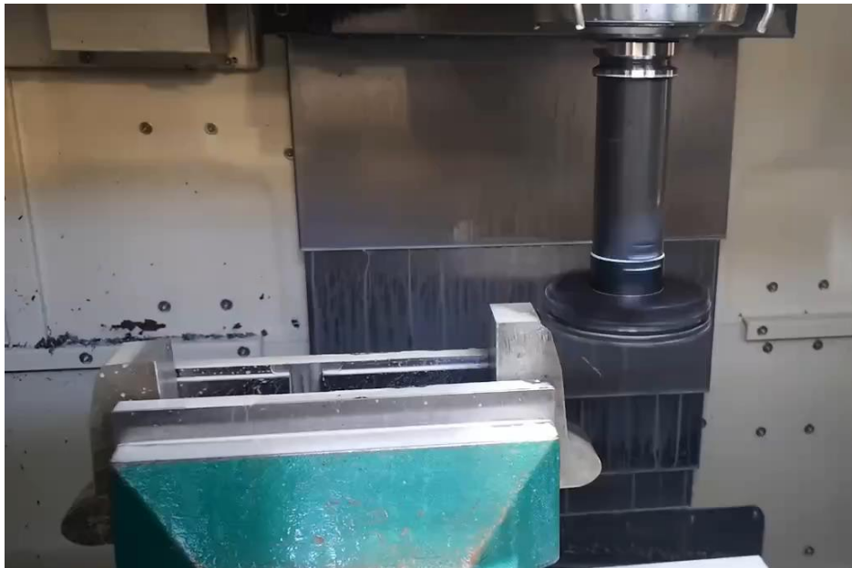
Рис. 5.1 – Дисковая фреза с СМП установленная на шпинделе станка.
