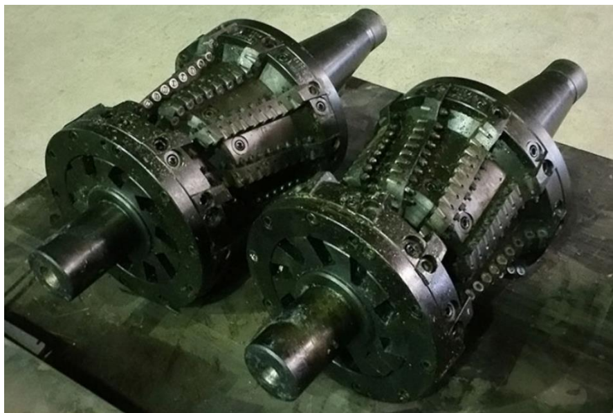
Рис. 2.8 – Сборная фасонная фреза для восстановления профиля бандажей колесных пар фирмы ЭФСИ, Россия.
