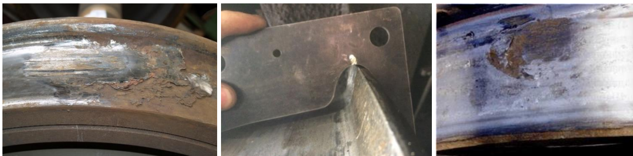
Рис. 1.6 – Ползун (а), остроконечный накат гребня (б), выщербина (в).
