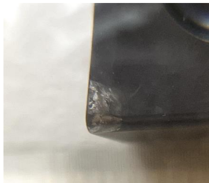
Рис. 5.6 – Износ по задней поверхности тангенциальных пластин LNНU 1306.
