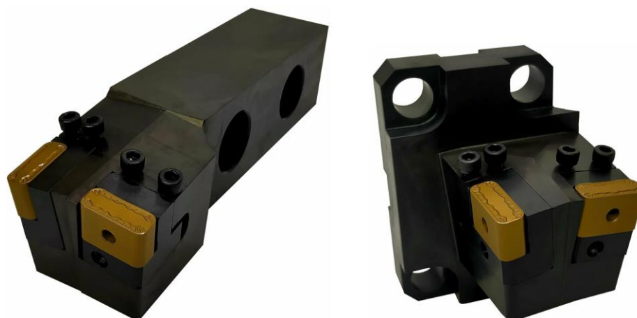
Рис. 2.11 – Токарный резец и резцовая головка фирмы ЭФСИ, Россия.
