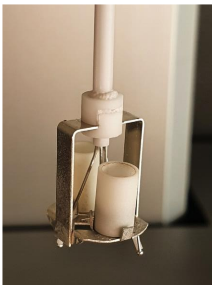
Рисунок 3.19 – ДСК-датчик (Pt/PtRh) с тиглями из \text{Al}_2\text{O}_3
