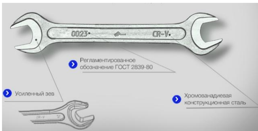
Рисунок 1.7. Гаечный ключ (ГОСТ 2839 – 80) [6, 105, 106]
