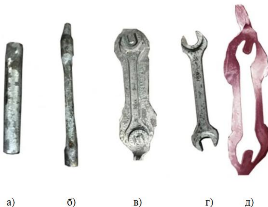
Рисунок 1.9. Традиционная технология штамповки заготовок гаечных ключей из прутка с использованием валковой прокатки и открытых штампов в производстве слесарного инструмента в соответствии с ГОСТ 2310-77, ГОСТ 11516-94 (Россия): а – исходная заготовка; б – валковая прокатка; в – штамповка на молоте г – обрезка; д – отходы (облой)
