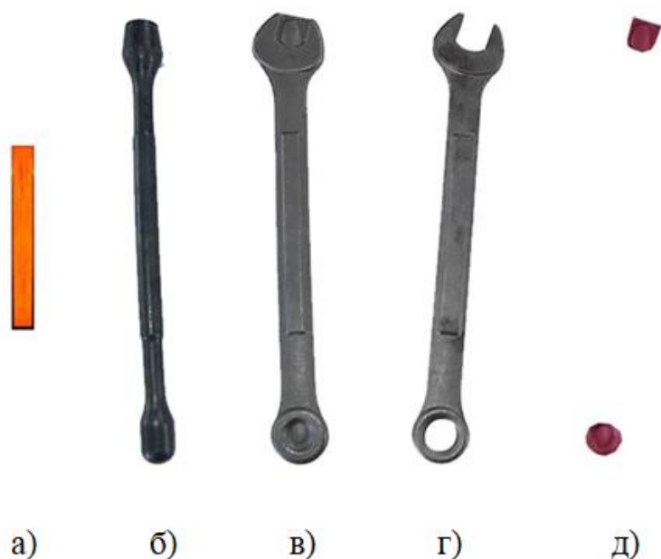
Рисунок 1.10. Технология бережливого производства гаечных ключей с использованием технологии поперечно-клиновой прокатки на станах WRL производства ООО «Инженерный центр «АМТинжиниринг»: а – исходная заготовка; б – поперечно-клиновая прокатка; в – г – штамповка в закрытых штампах на КГШП; д – отходы
