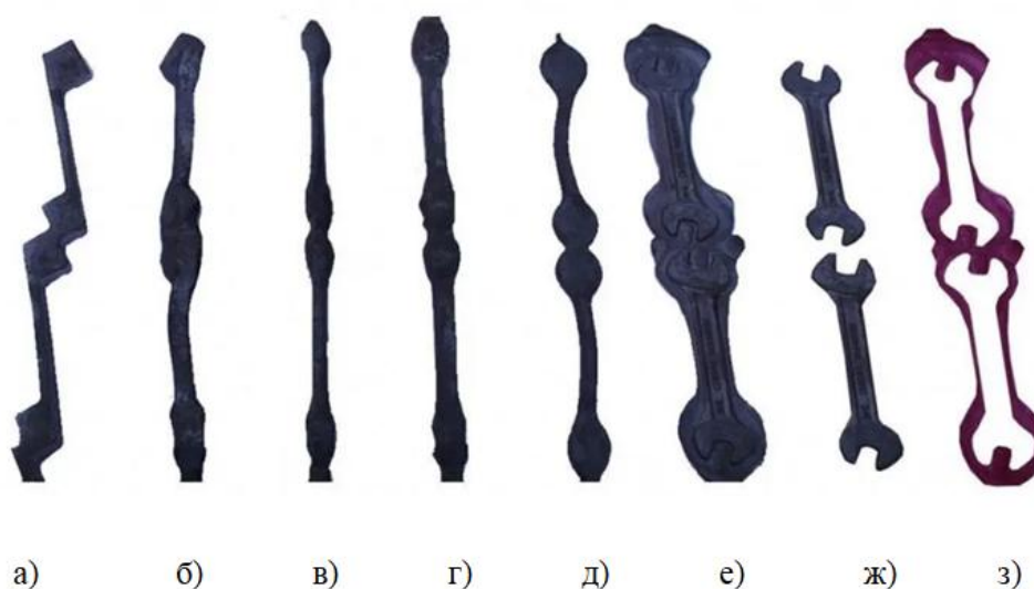
Рисунок 1.12. Технология штамповки сдвоенных заготовок гаечных ключей из листовой заготовки (Индия): а – исходная заготовка; б– г – прокатка; д – ж – штамповка на молоте; з – отходы (облой)
