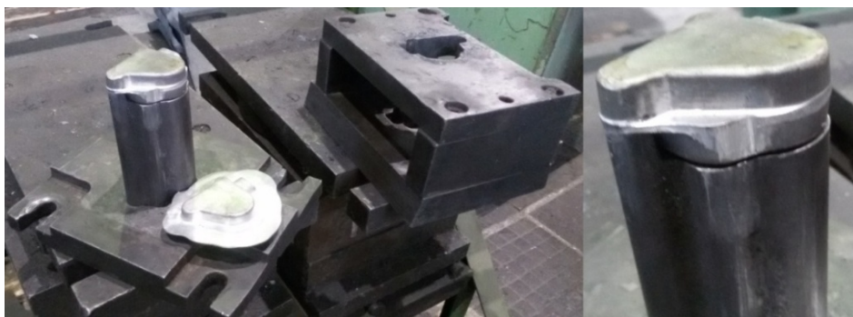
Рис. 1.9. Задиры на поковке и рабочих элементах обрезного штампа
