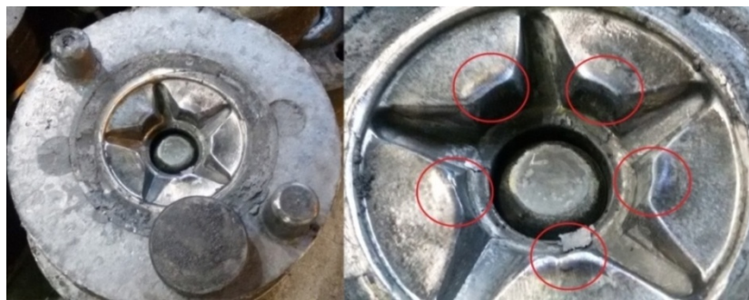
Рис. 1.4. Деформация кромок, приводящая к увеличению уклона и искажению гравюры штампа для ГОШ
