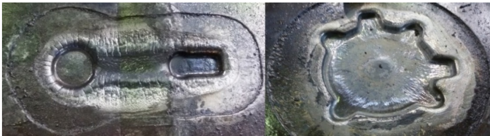
Рис. 1.6. Образование разгарных трещин на гравюре штампа для ГОШ
