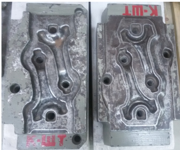
Рис. 1.1. Вставки штампа КГШП для изготовления поковки детали «шатун»
