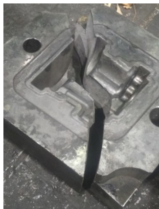
Рис. 1.7. Разрушение штампа ГОШ
