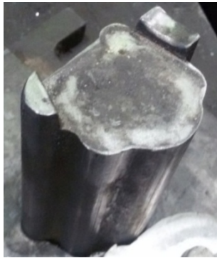
Рис. 1.8. Затупление режущих кромок пуансона обрезного штампа
