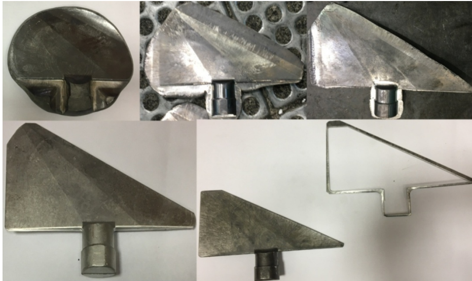
Рис. 2.3. Поковки после различных переходов штамповки по производственному техпроцессу
