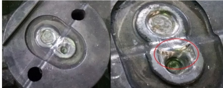
Рис. 1.5. Смятие гравюры штампа для ГОШ вследствие изменения механических характеристик в результате отпуска
