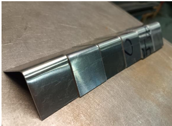
Рисунок 3.25 – Место контакта заготовки из Амг3М с матрицей
