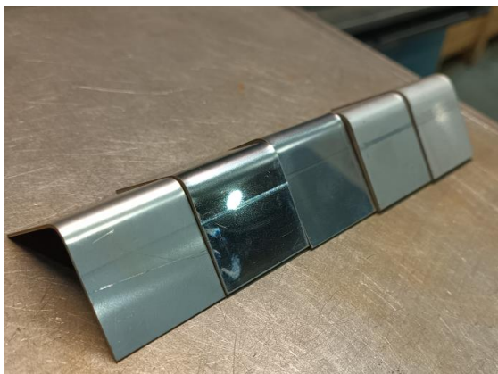
Рисунок 3.26 – Место контакта заготовки из AISI 304 с матрицей
