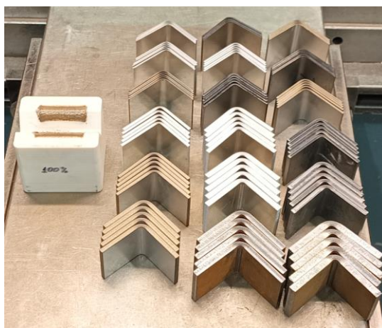
Рисунок 3.24 – Матрица со 100 % внутренним заполнением и согнутые на ней образцы металла
