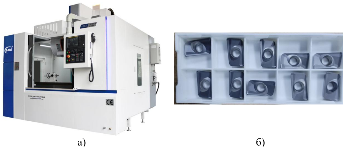
Рис. 2.11. Вертикальный обрабатывающий центр Power V10 производства фирмы Z-МаТ, КНР (а) и твердосплавные фрезерные пластины АРМТ1604-Н2 (б)
