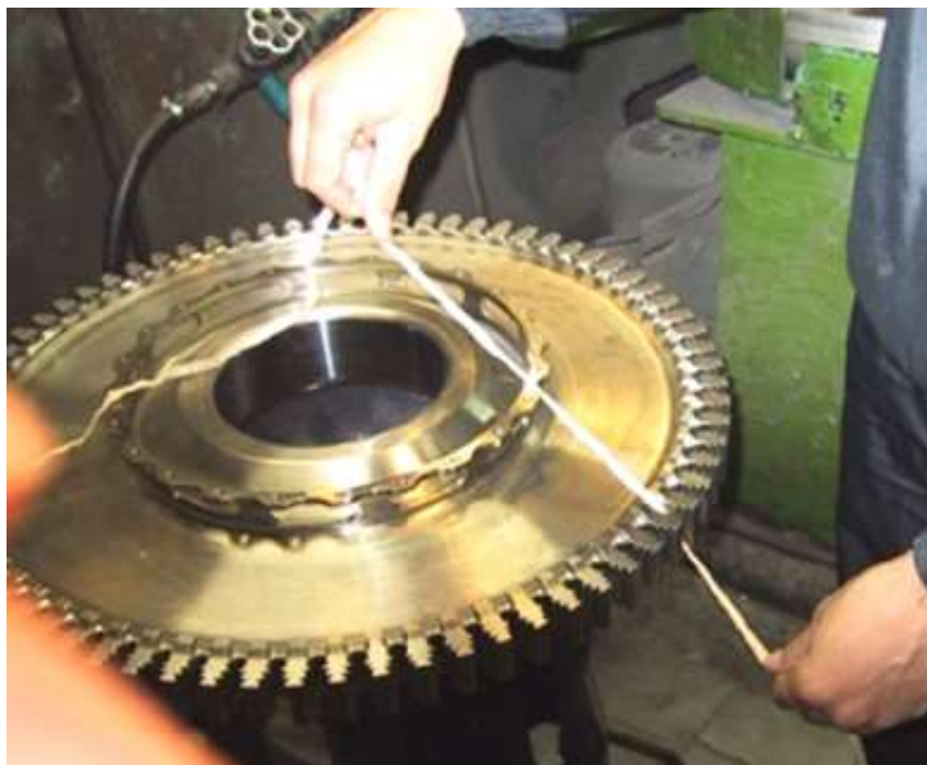
Рисунок 1.5 – Слесарная обработка кромок диска ротора ГТД в условиях ПАО «ОДК-САТУРН»
