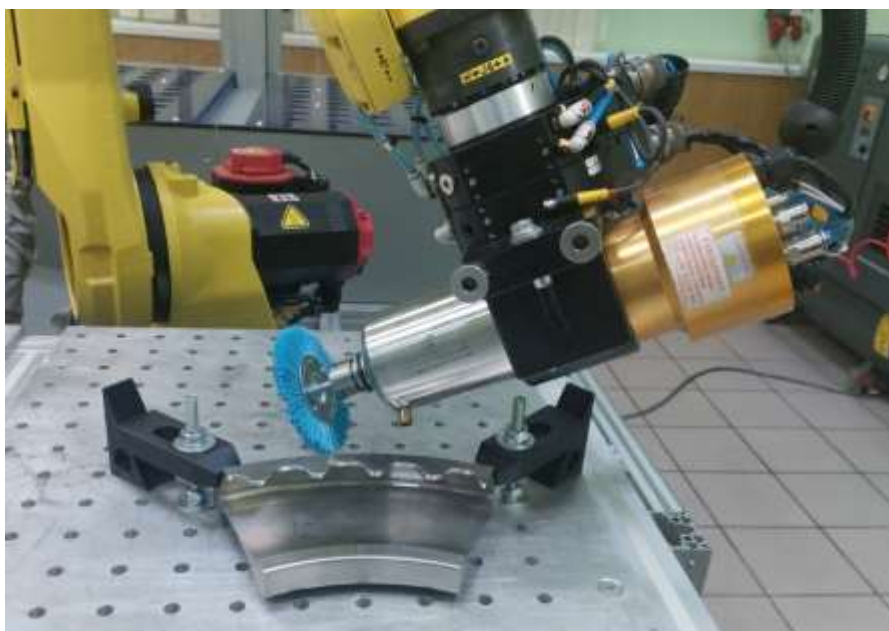
Рисунок 1.7 – РТК по удалению заусенцев деталей ГТД в РГАТУ имени П.А.
