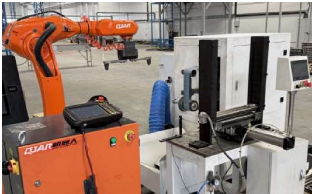
Рисунок 1.6 – РТК по зачистке сварных швов ООО «РОЯЛ ТЕРМО РУС», г. Киржач
