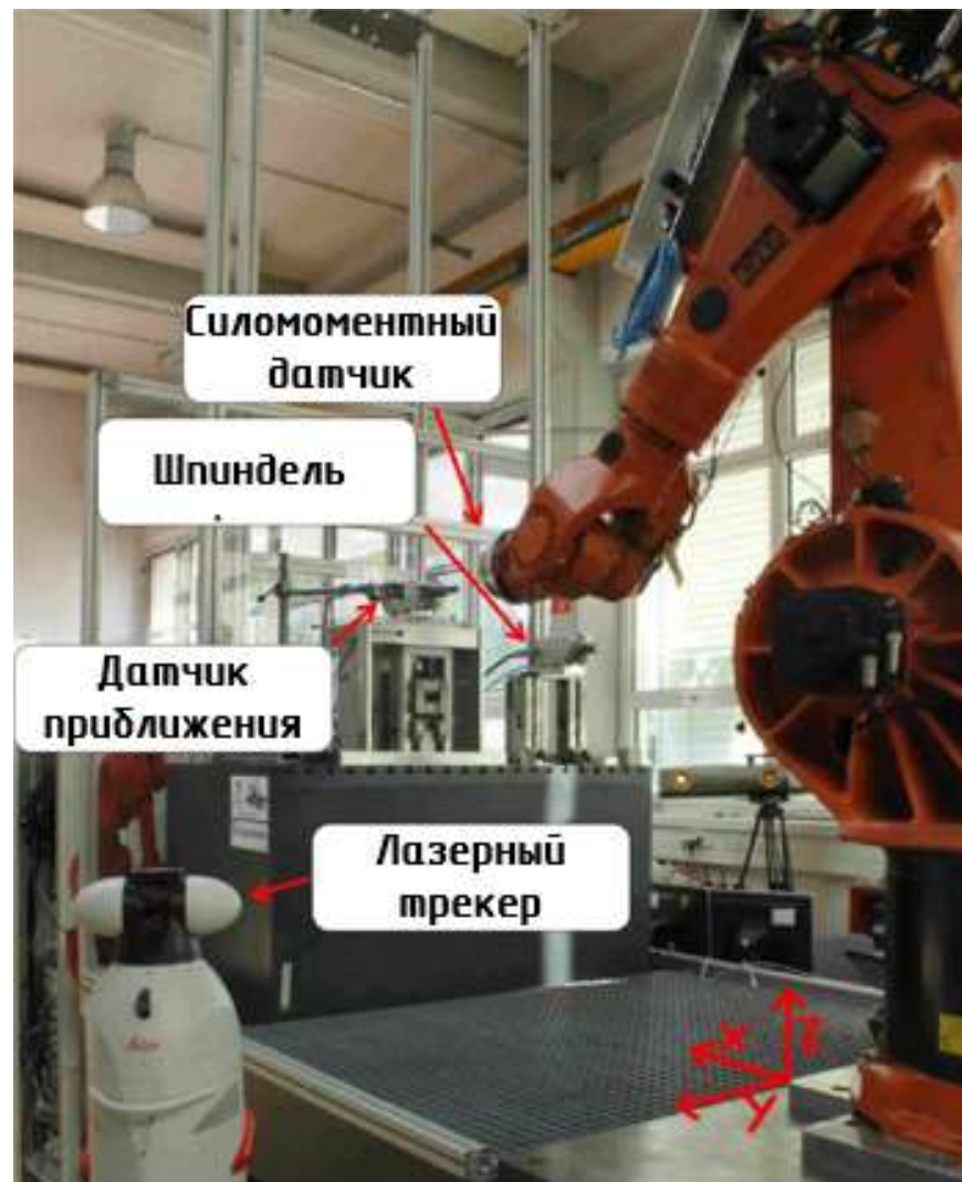
Рисунок 1.12 – Экспериментальная установка на базе робота KUKA KR125
