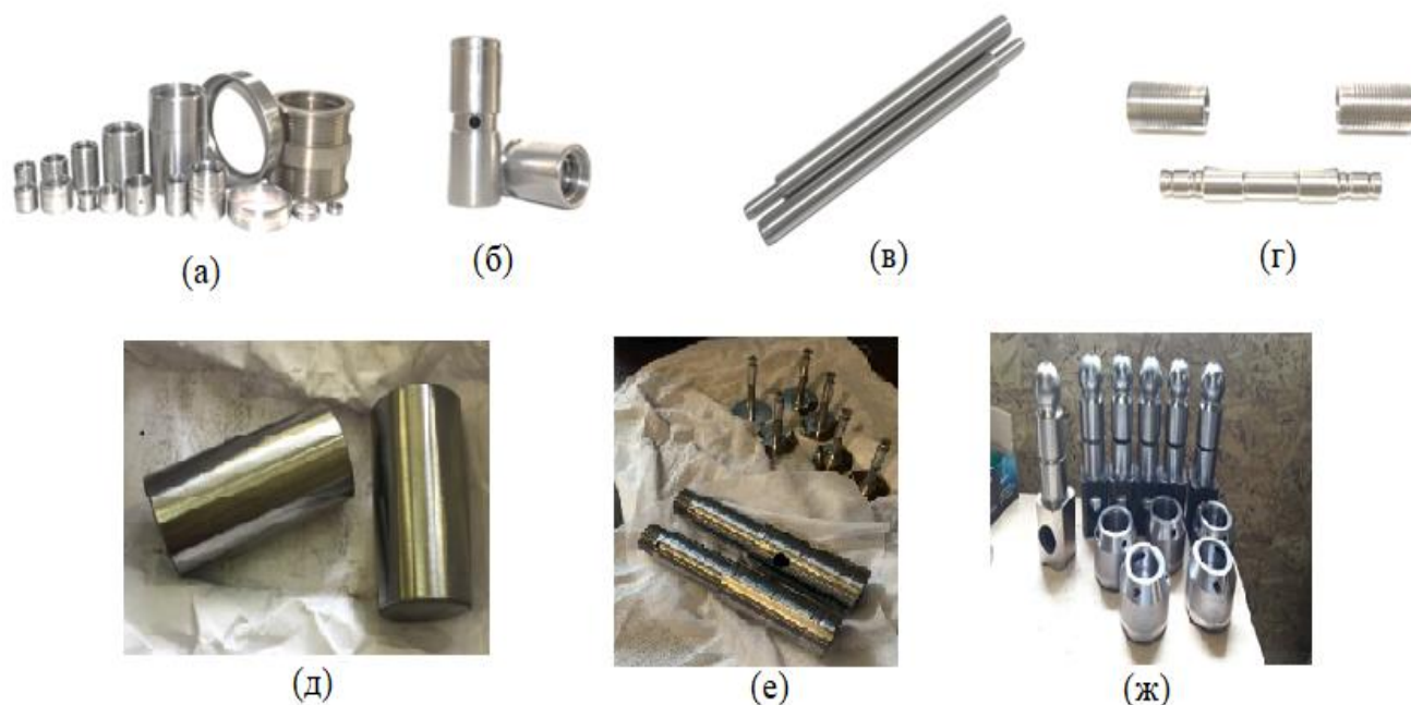
Рисунок 1.1 – Пример изделий из закаленной шарикоподшипниковой стали ШХ15: а) разнообразные кольца подшипников; б) стабилизаторных втулок, (в) валики, и (г) роликовый подшипник для текстильного оборудования; (д) ролики и тела качения; (е) клапана; (ж) толкатели.
