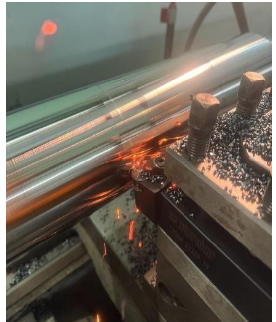
(б) точение стали ШХ15
