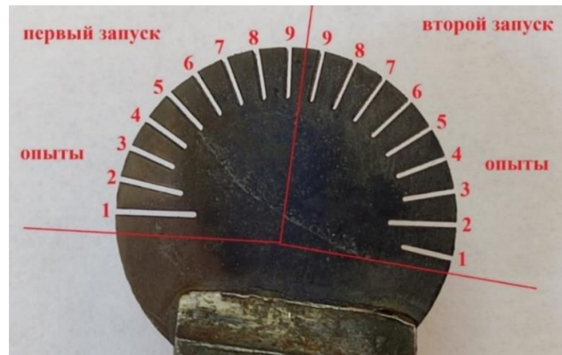
Рисунок 3.14 – Керамический образец после исследования ЭЭО
