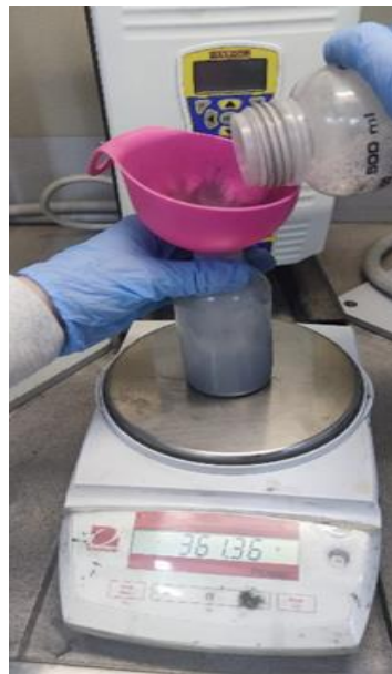
Рисунок 2.2 – Процесс смешивания исходных порошков: а) взвешивания порошка; б) засыпание керамических шариков из SiC ; в) добавление жидкой среды
