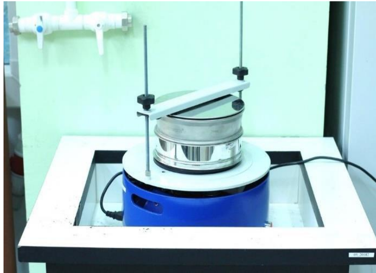
Рисунок 2.1- Просеивание исходных порошков на ситовом анализаторе [85]
