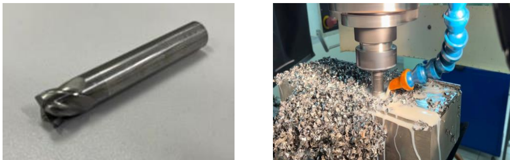
Рис. 11. Концевая фреза и обработка титановой заготовки с СОЖ
