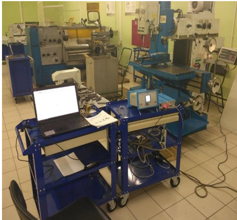
Рисунок 2.9. Аппаратура динамометра Kistler (Заготовки из сплава, установленные на чувствительную платформу динамометра).
