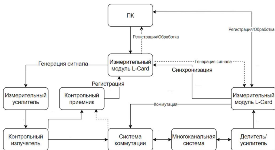
Рис 3. Структурная модель автоматизированного процесса контроля качества
