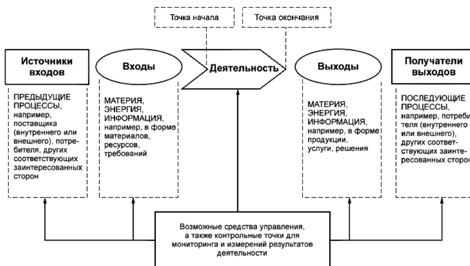
Рисунок 2.7. – Схема проведения контроля качества согласно нормативным документам.
