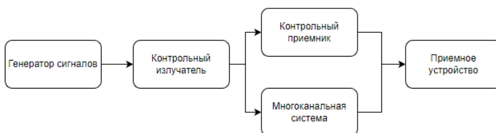
Рисунок 2.9. – Схема измерений с излучателем и приемником.
