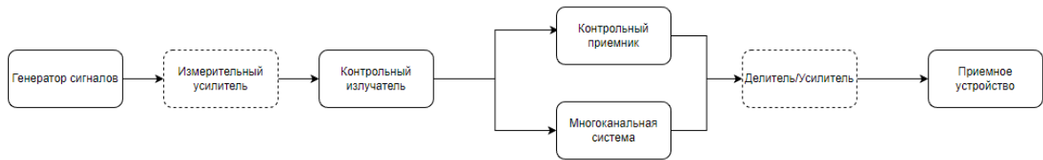
Рисунок 2.10. – Общая схема проведения контроля качества преобразователей
