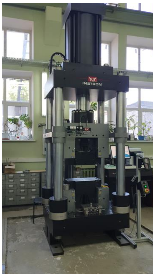
Рис. 6.7. Испытательная машина INSTRON KPX 3500 с компьютерной обработкой данных
