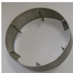
Рис. 3.3. Сварное кольцо, изготовленное сверткой панели с ребрами
