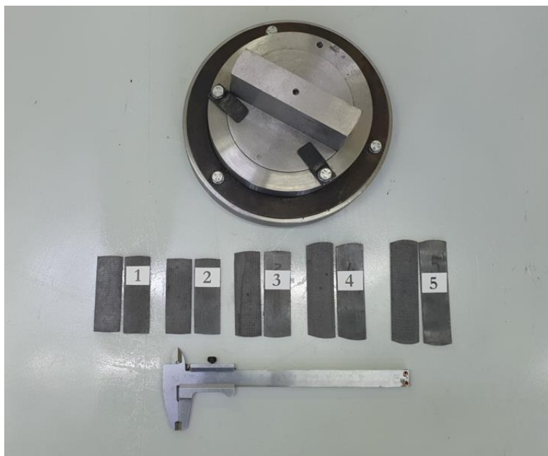
Рис. 6.1. Штамповая оснастка и образцы полос из свинца до начала эксперимента (1) и образцы, деформированные во время эксперимента (2-5)
