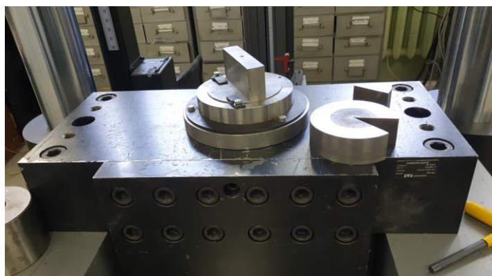
Рис. 6.8. Постановка эксперимента на сжатие тонких пластин прямоугольной формы в штампе с неподвижными стенками
