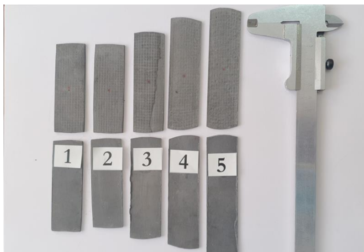
Рис. 6.12. Образцы с деформированной координатной сеткой при толщине h_1 = 3,5 мм, h_2 = 3,2 мм, h_3 = 2,9 мм, h_4 = 2,0 мм, h_5 = 1,5 мм
