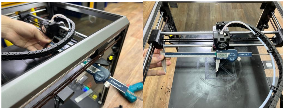
Рис. 2, 3. Нахождение центрального положения печатающей головы по X
