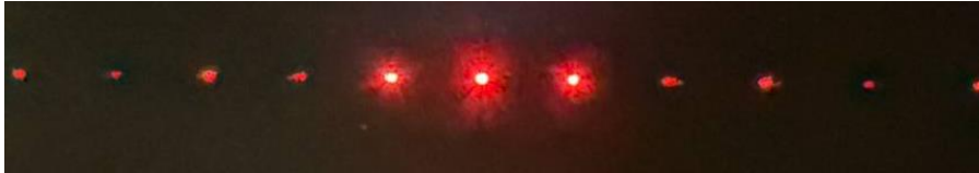
Рис. 1. Дифракция на решетке Heidenhain
