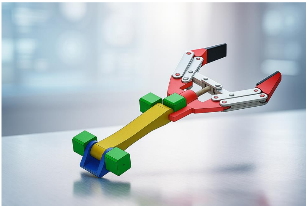
Рис. 1. Общий вид двухпальцевого захвата, разработанного в T-FLEX CAD
