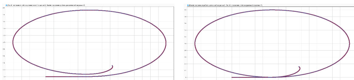
Рис. 1. Траектория движения мобильной платформы без учёта сил сопротивления грунтов (слева) и с учётом сил сопротивления грунтов (справа)
