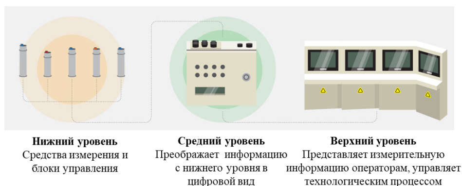
Рис. 1. Автоматизированная система контроля выбросов
