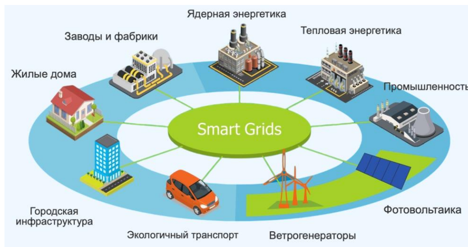
Рис. 1. Smart Grid – умная энергосеть, которая управляет распределением электроэнергии, учитывая потребности потребителей и производителей
