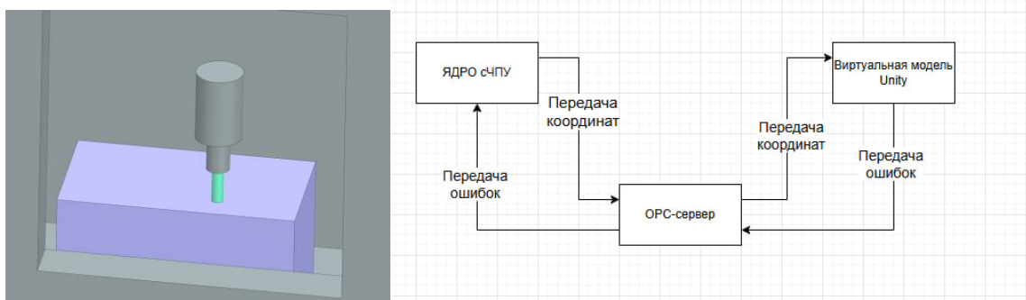
Рис. 1. Трёхмерная модель станка и схема взаимодействия
