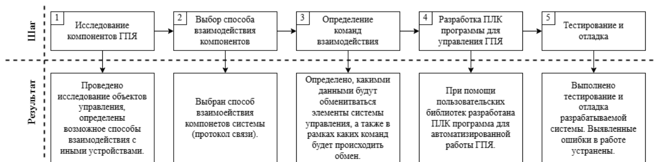
Рис. 2. Методика взаимодействия системы ЧПУ с промышленным роботом в рамках построения ГПЯ
