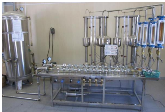
Рис. 1. Пример испытательного стенда на погрешность измерения при помощи эталонных мер вместимости
