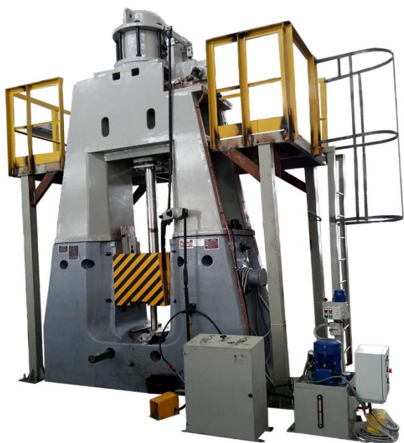
Рис. 2. Внешний вид паровоздушного молота М2145
