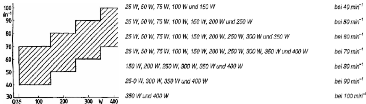
Рис. 4. Допустимая область поверочных значений по частоте вращения и мощности и типовые сочетания мощности (Вт) и частоты вращения (об/мин) при поверке
