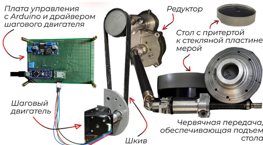
Рис. 2. Электромеханическая система для перемещения стола интерферометра
