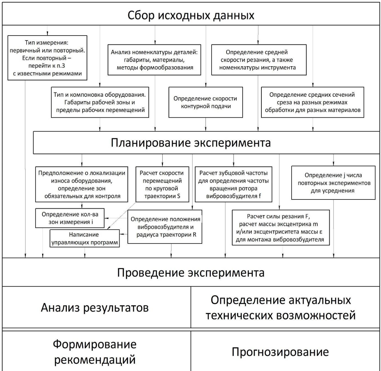
Рисунок 3.6 – Алгоритм определения точности и виброустойчивости круговых перемещений фрезерных станков
