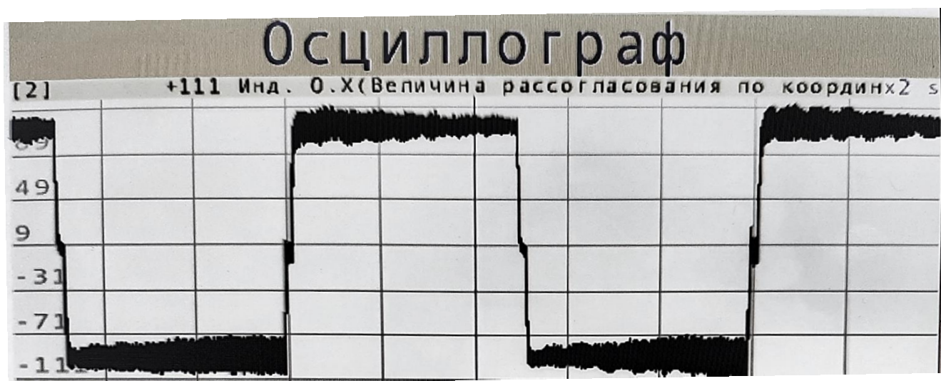
Рисунок 2.13 – Изменение размаха колебаний при попутно-встречном фрезеровании в зоне значительного градиента виброустойчивости
