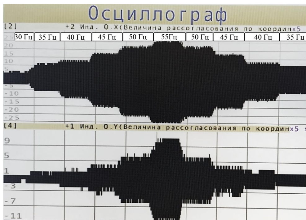
Рисунок 2.8 – Внешний вид осциллограммы, полученной в результате ступенчатого разгона-выбега
