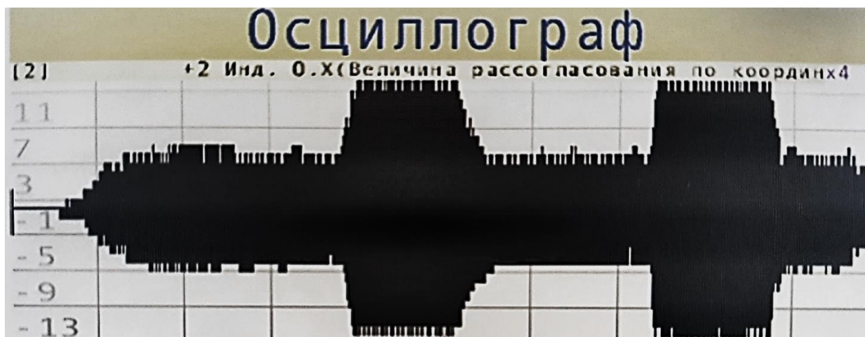
Рисунок 4.7 – Оциллограмма виброперемещений привода при включении и выключении демпфера
