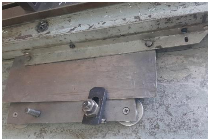
Рисунок 4.6 – Внешний вид вибродемпфирующего устройства с постоянными магнитами
