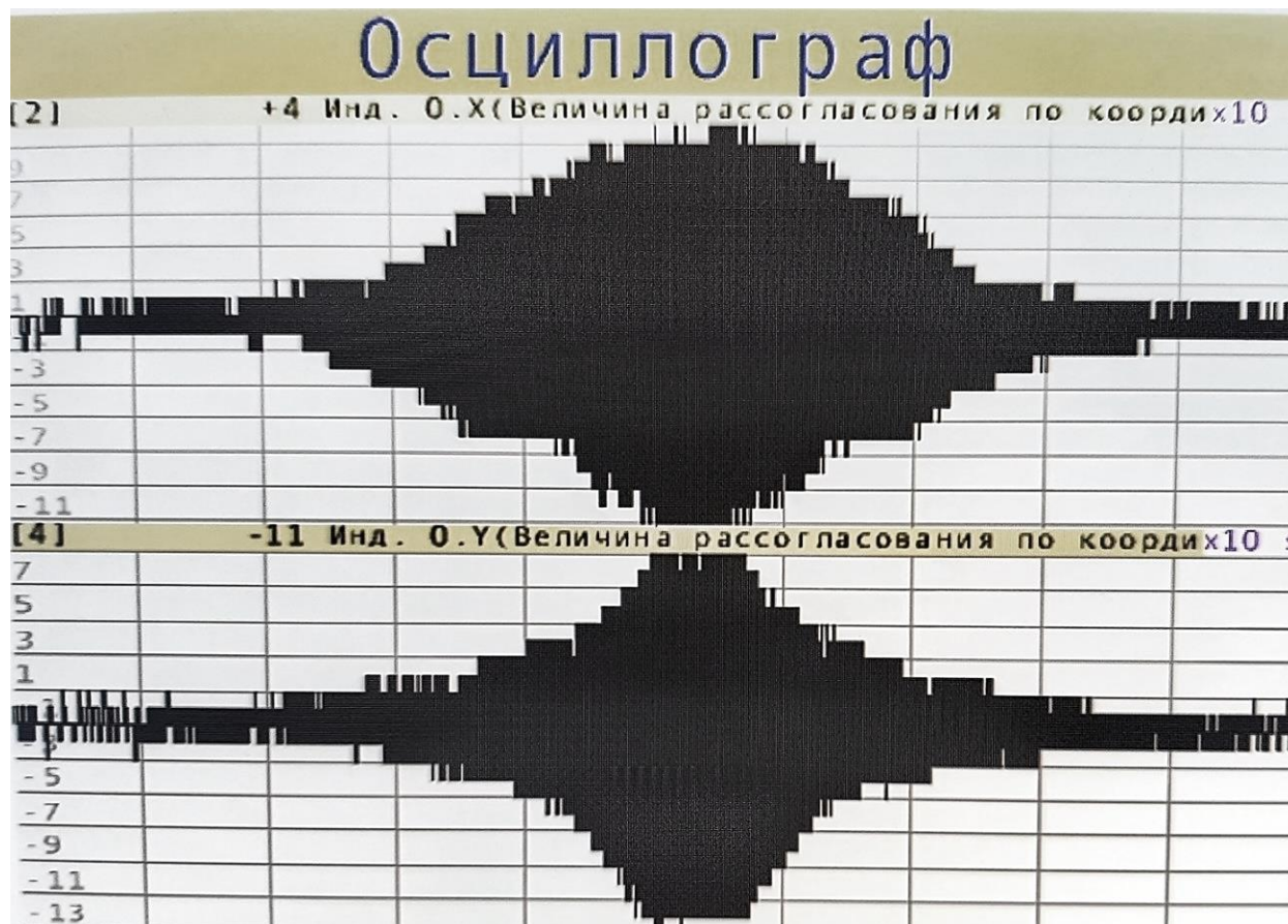
Рисунок 2.7 – Внешний вид осциллограммы, полученной в ходе разгона-выбега
