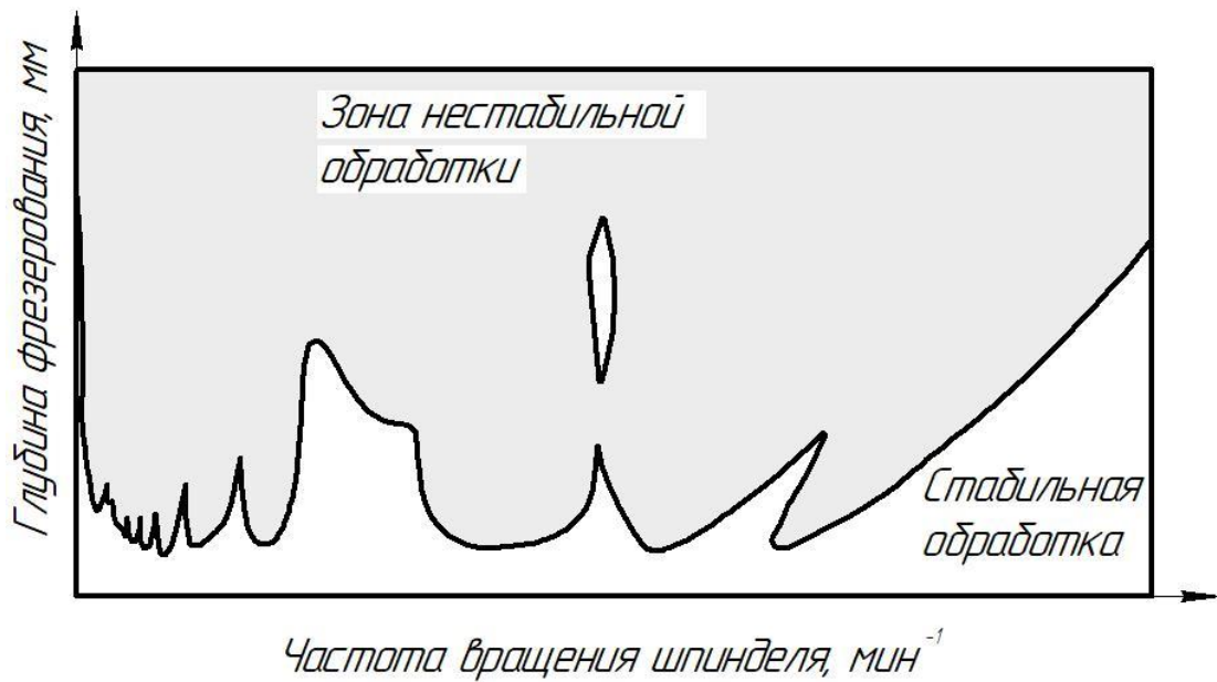
Рисунок 1.14 - Типичная лепестковая диаграмма стабильности при фрезеровании
