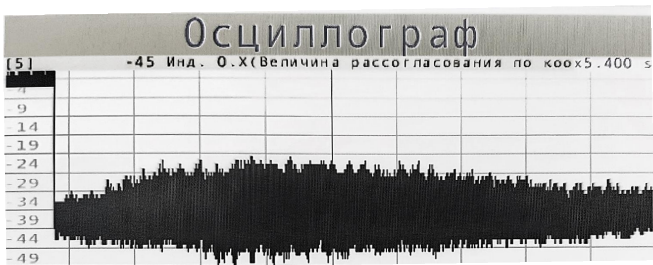
Рисунок 2.12 – Оценка амплитуды колебаний привода при движении вдоль всей оси X
