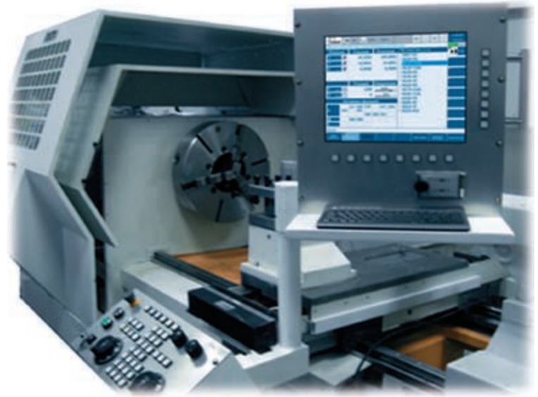
Рис. 4. Экспериментальный образец токарного станка СА700КФ2 (ОАО «САСТА») с комплектной системой управления (МГТУ «Станкин»)
