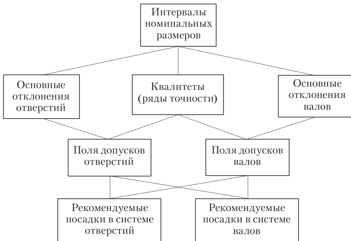
Структурная схема построения современной «Единой системы допусков и посадок» (ЕСДП) для гладких элементов деталей
