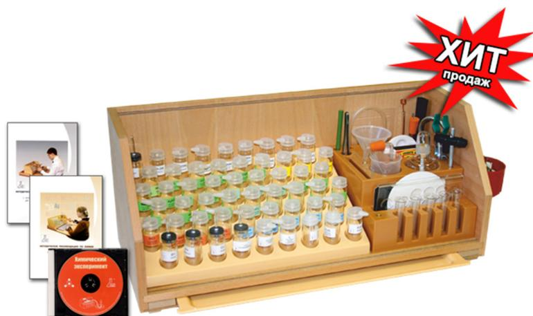
Микролаборатория для химического эксперимента представляет собой компактный набор лабораторного оборудования, посуды и малогабаритных приборов, позволяющий проводить до **60** лабораторных опытов и **30** практических работ в соответствии с программами основной и средней школы по неорганической и органической химии.
