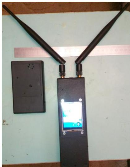
**Рис. 1.** Метка (слева) и устройство поиска (справа)
