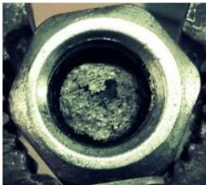
**Рис. 3.** Образец полученного углерода
