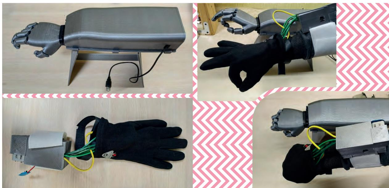
Рисунок 6 – Перчатка и прототип бионического протеза
