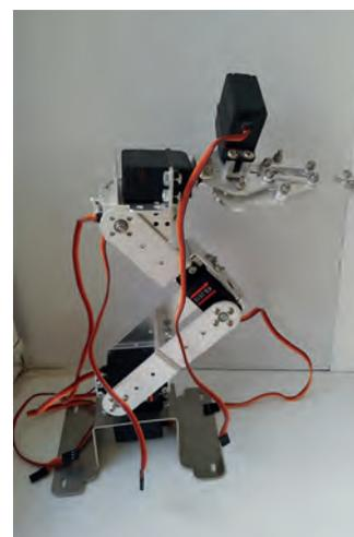
Рисунок 4 – Манипулятор и электронные компоненты управления
