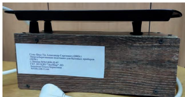
2. Контакты пускового реле замыкаются, и ток поступает на розетку для утюга. При установке утюга на подставку замыкаются контакты;
