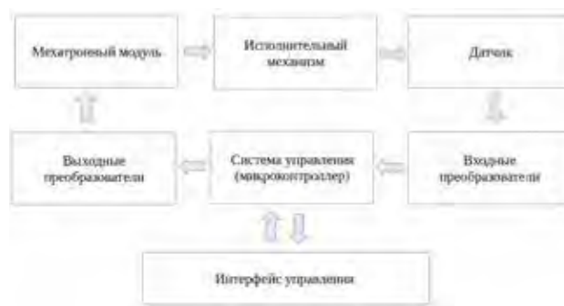
Рис. 1. Типовая мехатронная система
