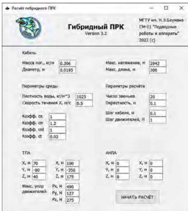
Рис. 2. Начальное окно ПО для моделирования конфигурации кабеля гибридного ПРК
