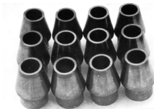
Рис. 4. Порошковые втулки со ступенчатой фланцевой частью из ПЖРВ3.160.24
