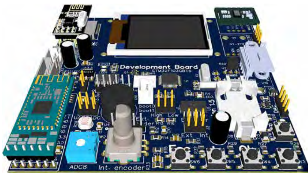
Рис. 3. 3D-модель модуля для прототипирования мехатронных устройств
