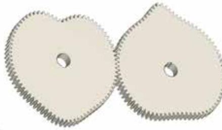
Рис. 2. Модель НЗК при передаточной функции i = 1.1 \cdot (0.942 \cdot \sin(x))^{17} + 1
