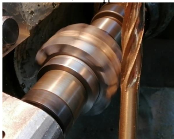
Рис. 26. Установка заготовки на станке PFAUTERRS00S и процесс обработки
