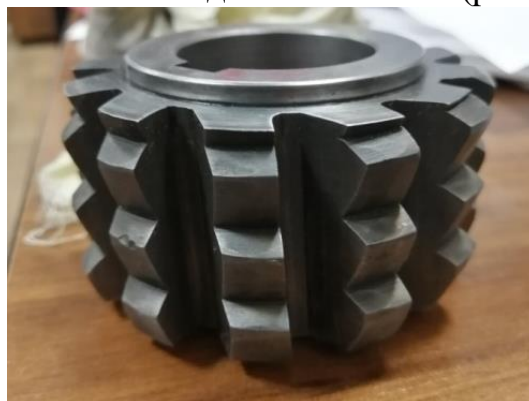
Рис. 25. Изготовленная специальная червячная фреза для обработки винтовых стружечных канавок концевых фрез
