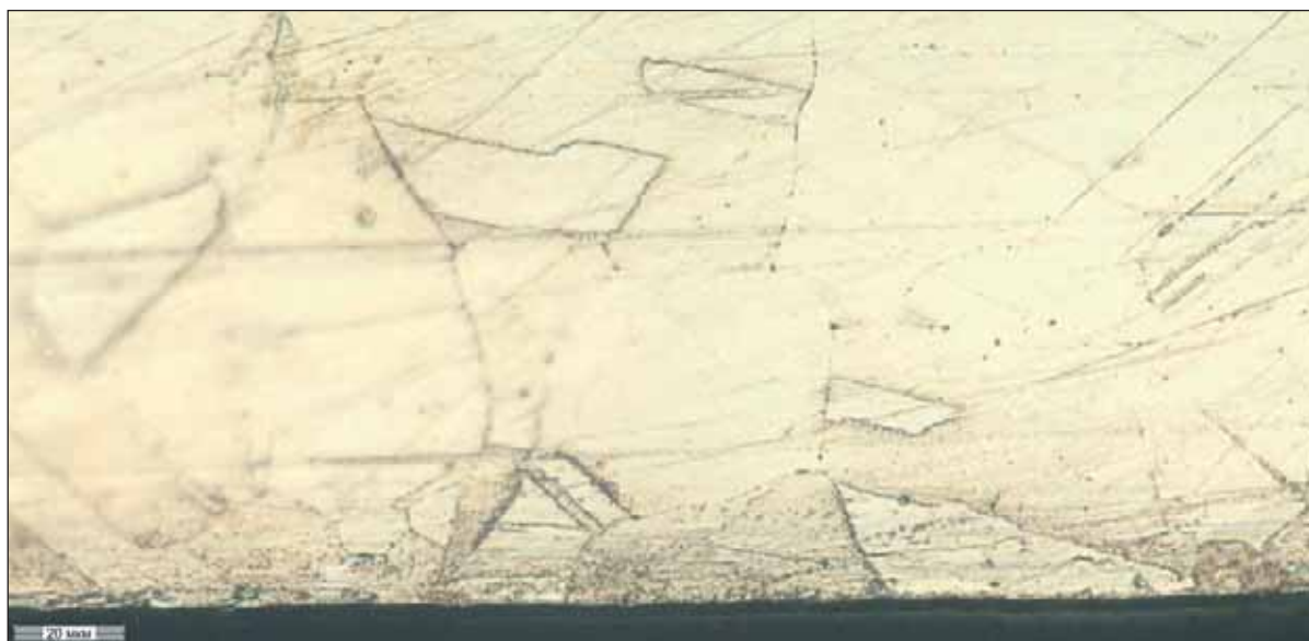
Рис. 9. Шлиф латунного образца после обработки (изображение на микроскопе Olympus GX 41)
