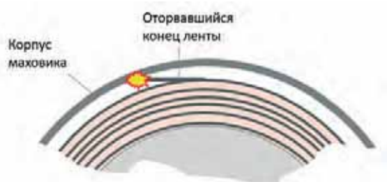
Рис. 7. К финальному решению: край ленты может автоматически выполнять функцию тормоза.
