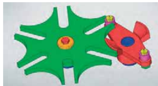
Рис. 10. Автоматическое формирование 3D-модели механизма внешнего зацепления с помощью программного приложения
