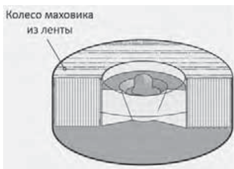
Рис. 6. Предварительное решение: колесо маховика в виде катушки, из прочной ленты или прочной проволоки
