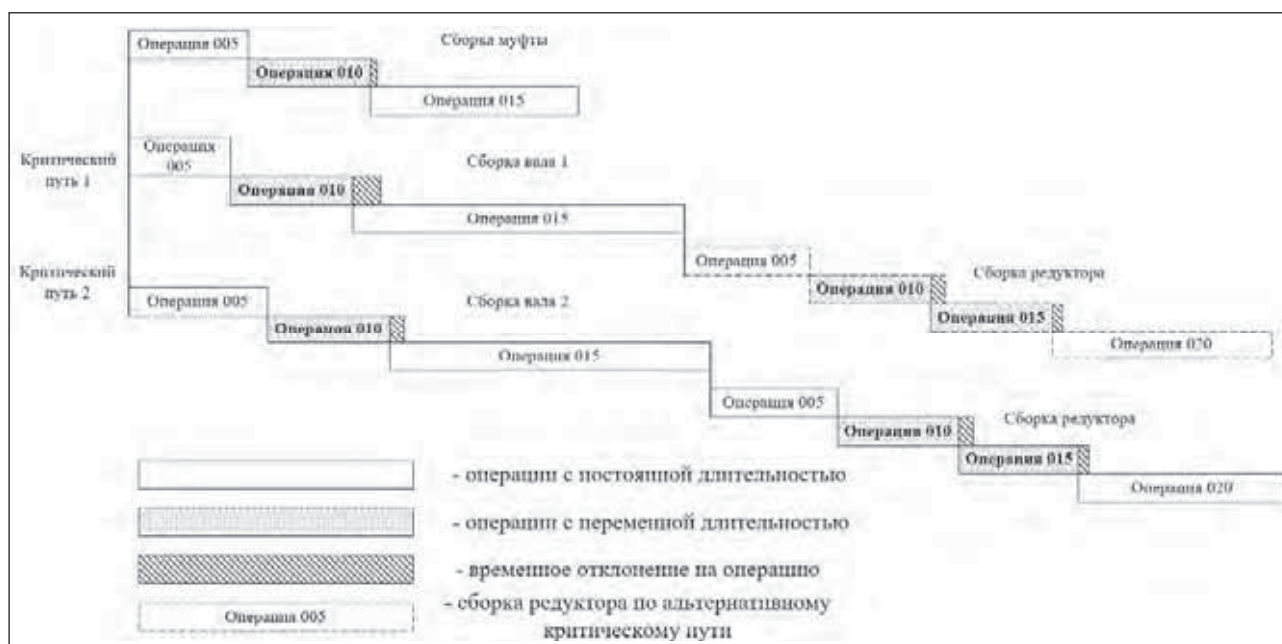
Рис. 1. Циклограмма процесса сборки редуктора
