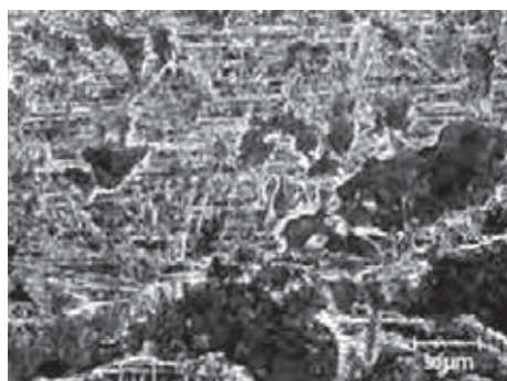
Рис. 3. Состояние поверхности латунного образца (увеличение в 125 раз): а – исходное состояние; б – состояние после обработки
