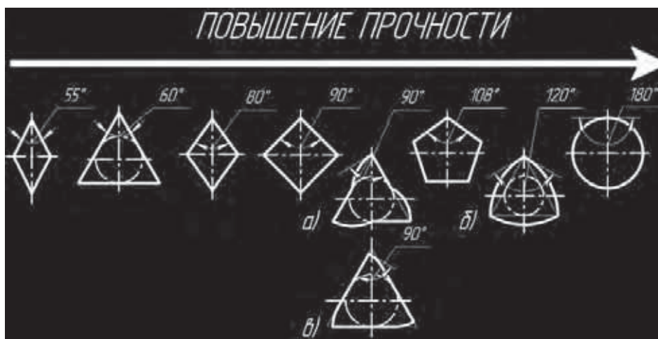
Рис. 8. Ранжирование форм сменных режущих твердосплавных пластин по повышению прочности. Разработанные пластины высокой прочности: а) пластина высокой прочности со скругленными боковыми сторонами, выполненными на 1/2 длины пластины (Патент № 2201316); б) пластина высокой прочности со скругленными боковыми сторонами, выполненными на всю длины пластины; в) пластина высокой прочности, со скругленной вспомогательной режущей кромкой (Патент № 2531336)
