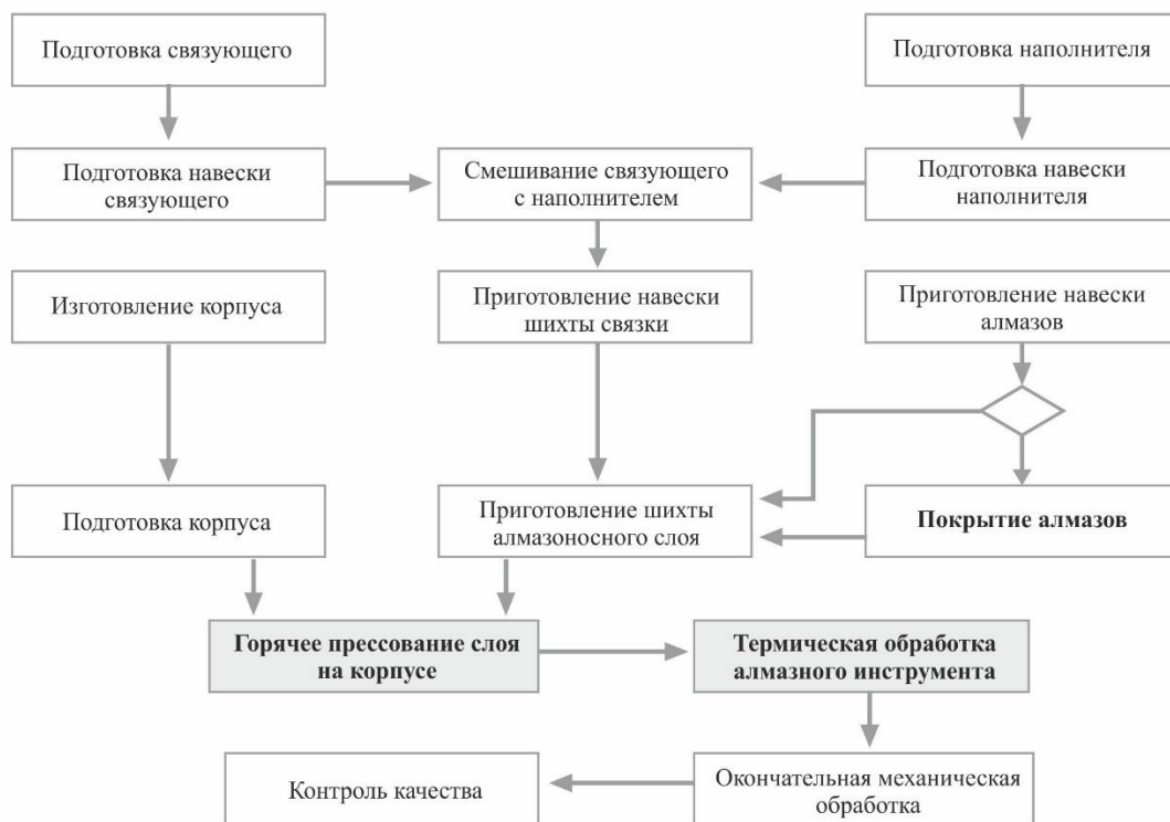
Рисунок 1.4 - Схема технологического процесса изготовления алмазного инструмента на полимерной матрице
