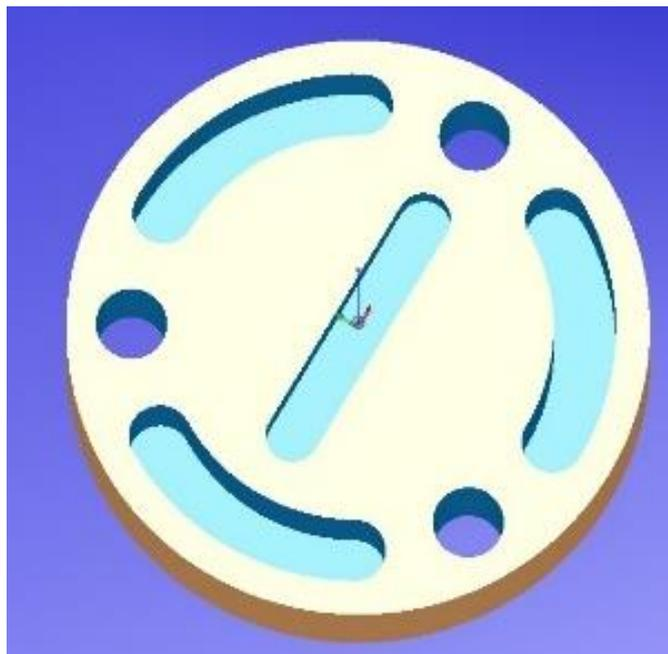
Рисунок 5.4 – Эмуляция фрезерной обработки в системе ЧПУ Fanuc
