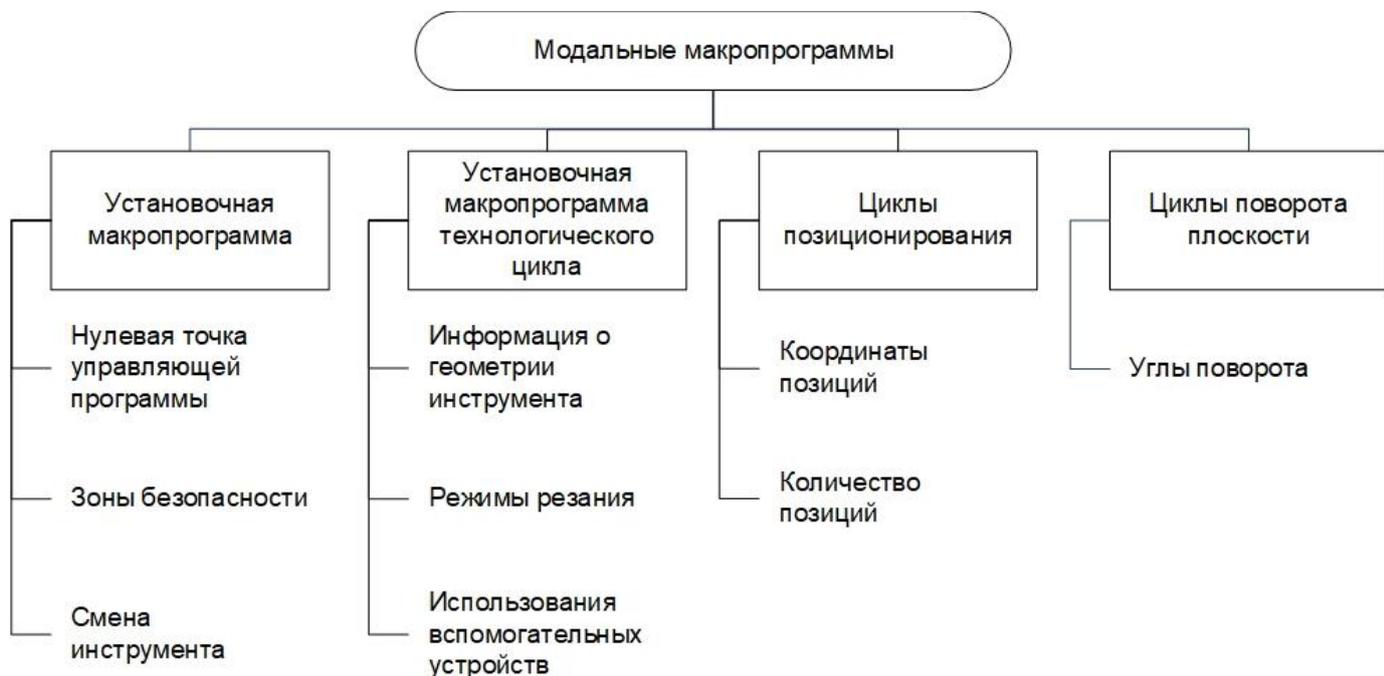
Рисунок 3.3 – Классификация переменных базовых подпрограмм
