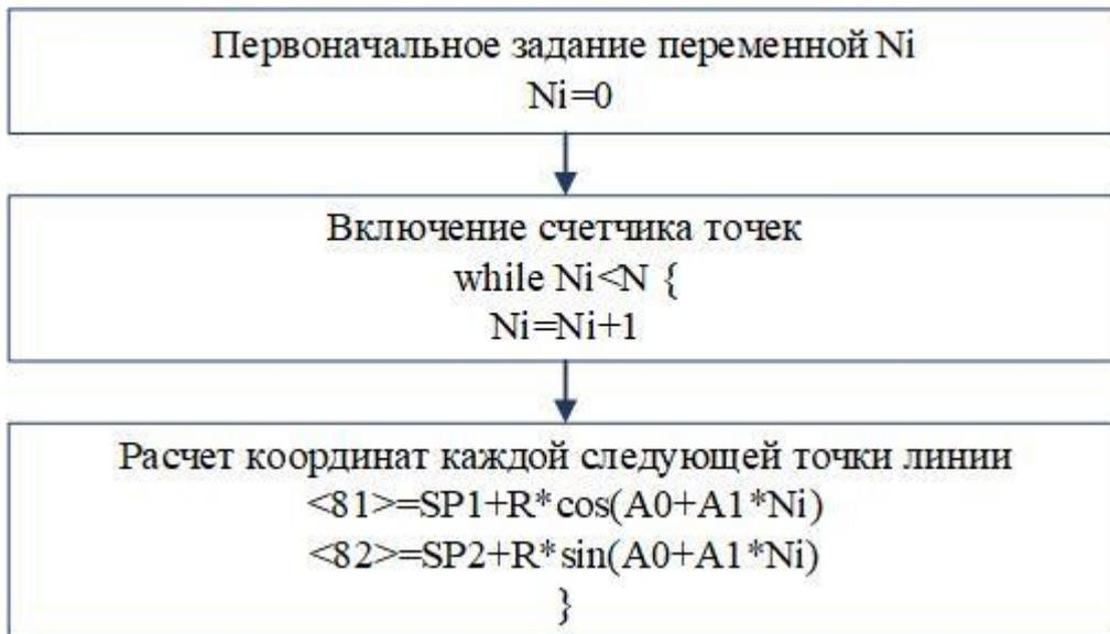
Рисунок 3.20 – Расчет координат точек массива позиций «Дуга»
