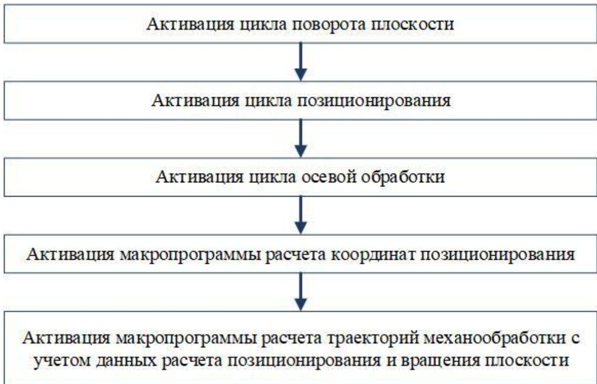
Рисунок 3.2 – Последовательность вызова макропрограмм
