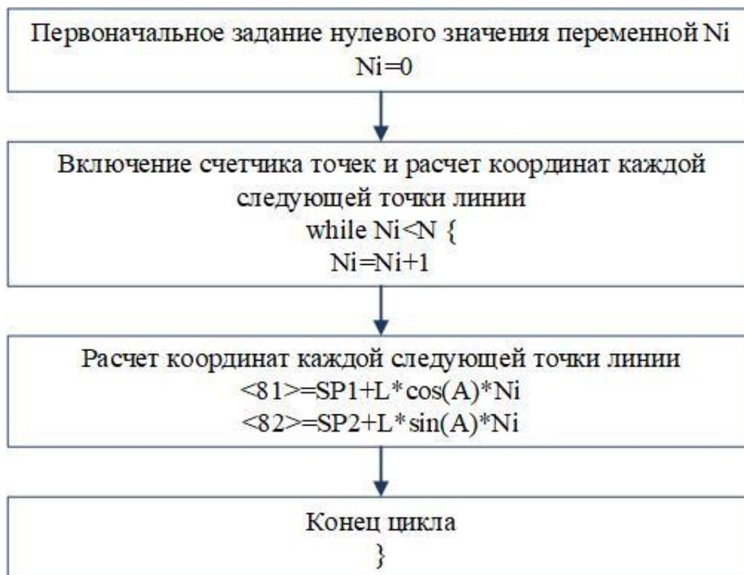
Рисунок 3.12 – Расчет координат точек массива позиций «Линия»
