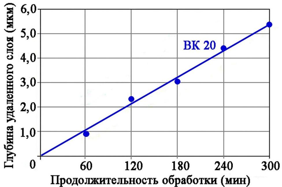
Рисунок 2.11 – Зависимости глубины удаленного слоя от продолжительности обработки поверхностного слоя атомами аргона для твердого сплава
