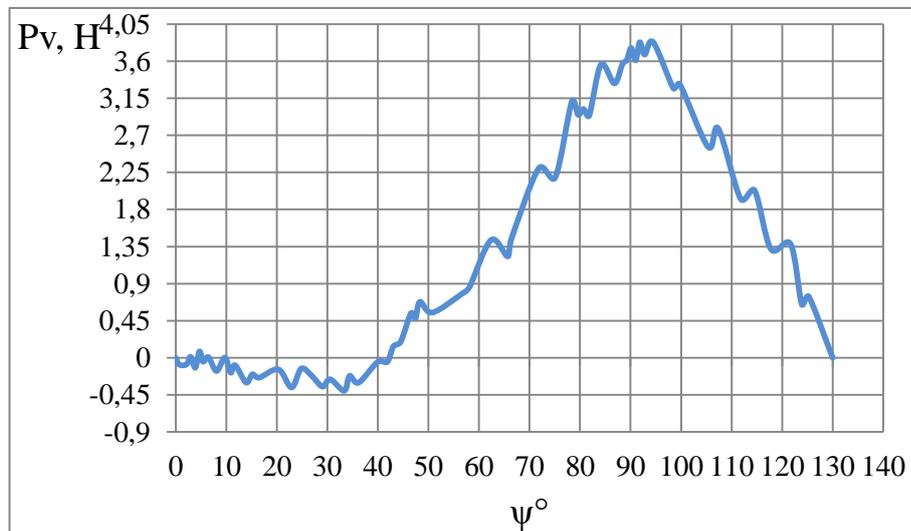
Рисунок 3.14 – Осциллограммы мгновенных значений силовых параметров и  $P_{oi}$  (1),  $P_{hi}$  (2) и  $P_{vi}$  (3), масштабированные относительно угла поворота зуба фрезы  $\psi$  в течении всего периода его рабочего хода
