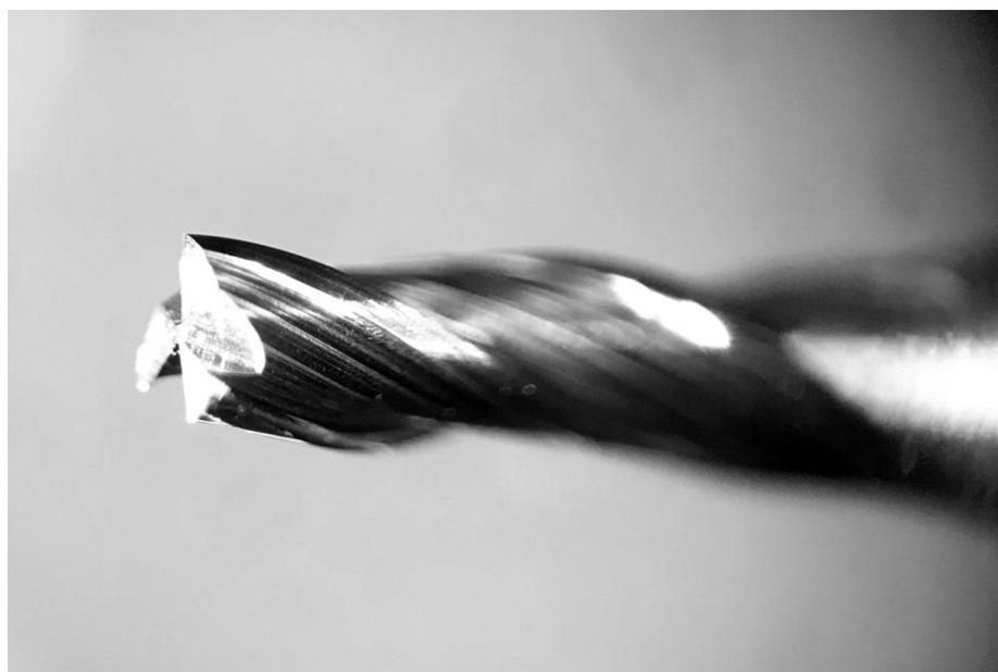
Рисунок 2.6 – Фотография концевой фрезы диаметром 1 мм с углом наклона стружечной канавки 30 градусов
