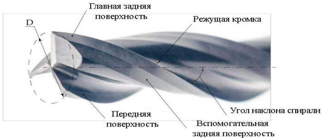
Рисунок 2.1 – Фотография концевой фрезы диаметром 3 мм с углом наклона стружечной канавки 30 градусов
