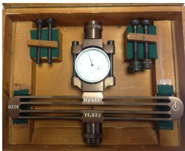
Рисунок 3.4 – Динамометр образцовый системы Токаря на сжатие
