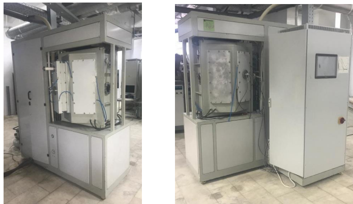
Рисунок 2 – Схема формирования пучка быстрых нейтральных атомов при заточке микрофрез (а) и общий вид (фото с двух ракурсов) вакуумно-плазменного оборудования (б) для комплексной плазменно-пучковой модификации твердосплавных концевых микрофрез
