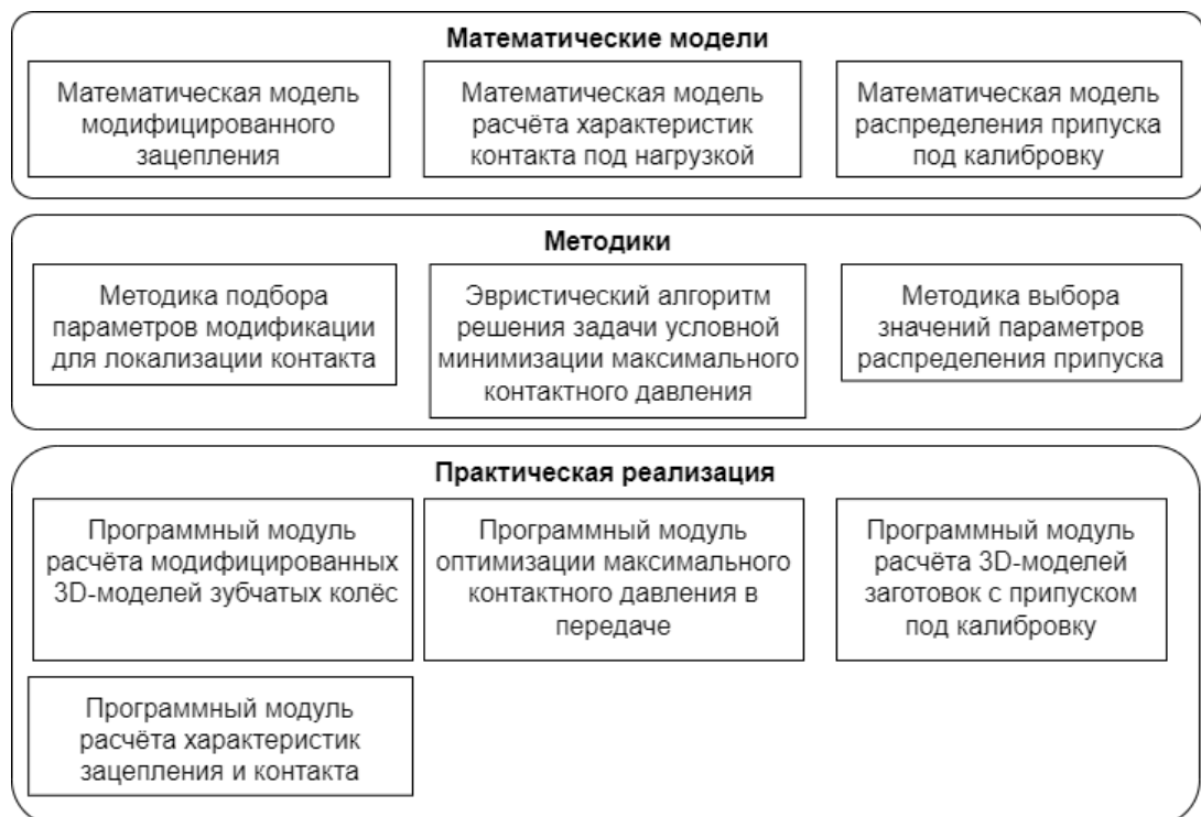
Рисунок 4.7 – Структура подсистемы технологического синтеза прямозубых конических передач в составе АСТПП
