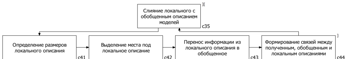
Рисунок 3.47 – Слияние локального с обобщенным описанием моделей в рамках алгоритма интеграции спецификаций V1
