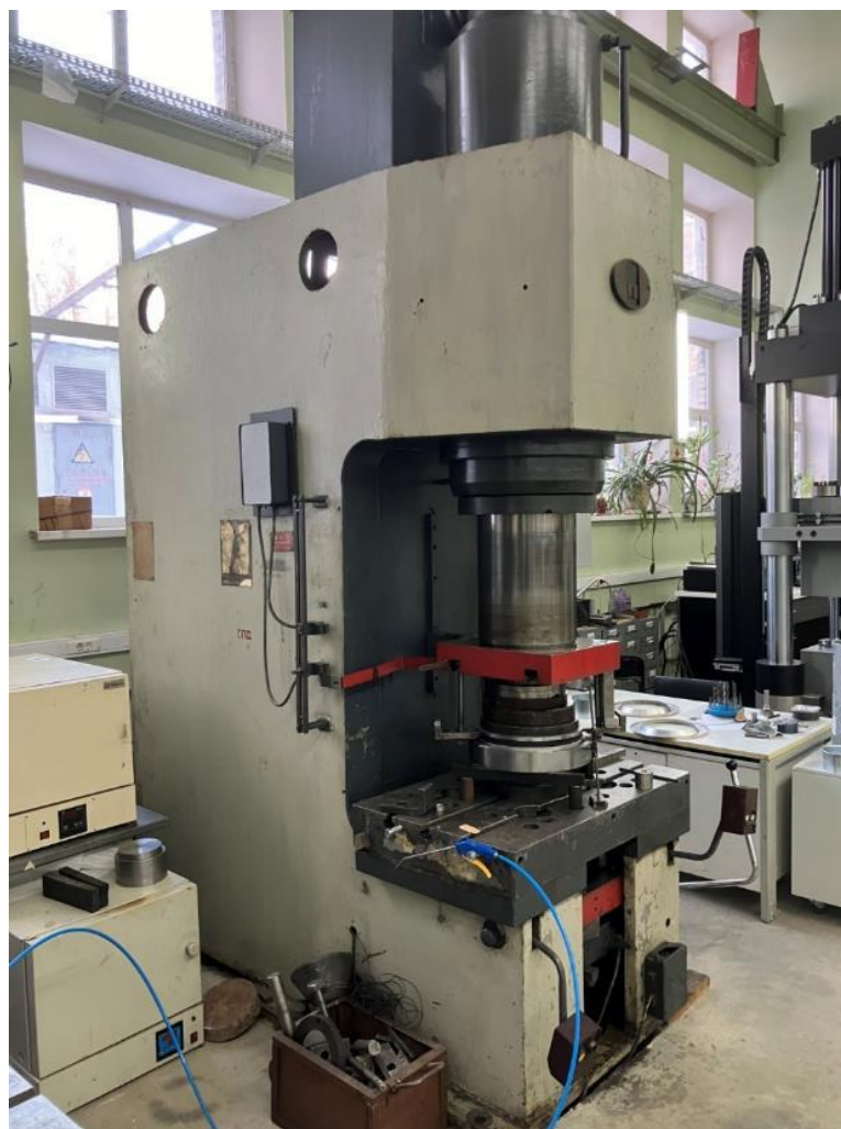
Рисунок 4.6 – Гидравлический пресс, на котором получены прутковые заготовки прессованием
