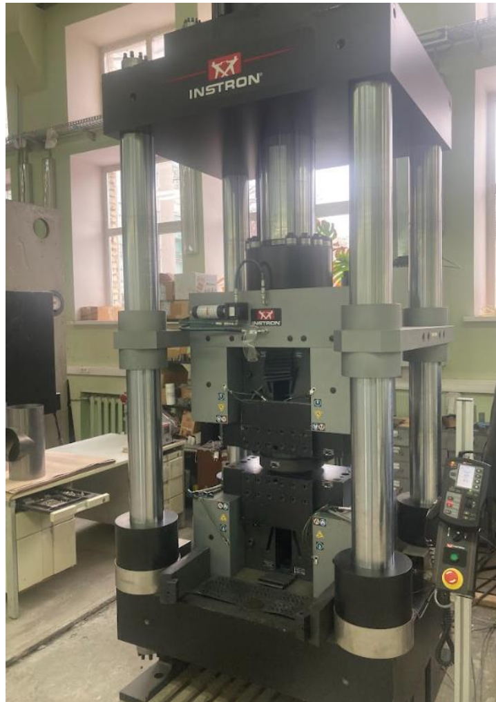
Рисунок 4.9 – Испытательный комплекс INSTRON KPX 3500
