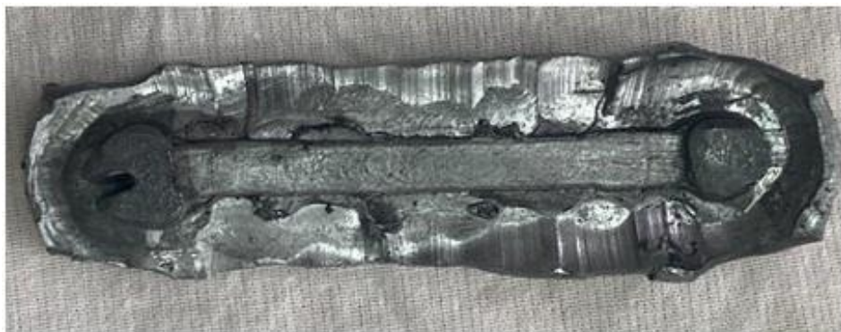
Рисунок 4.11 – Полученная поковка гаечного ключа
