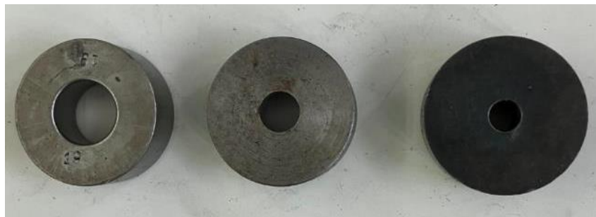
Рисунок 4.5 – Матричные вставки для прессования прутковых заготовок диаметрами \varnothing 18, 12, 8 мм
