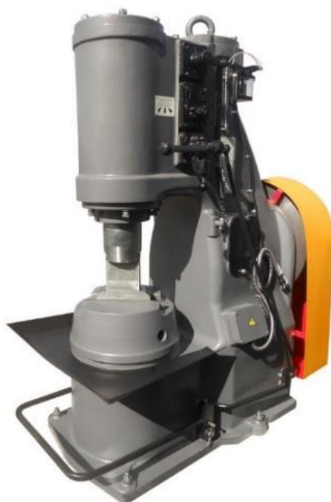
Рисунок 2.15 – Вертикальный ковочный пневматический молот МА4129
