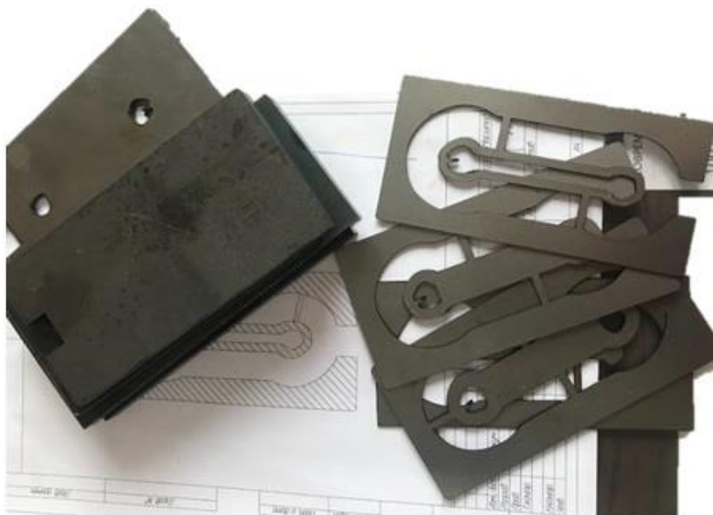
Рисунок 4.1 – Послойная сборка штампа из нескольких составляющих его пластин
