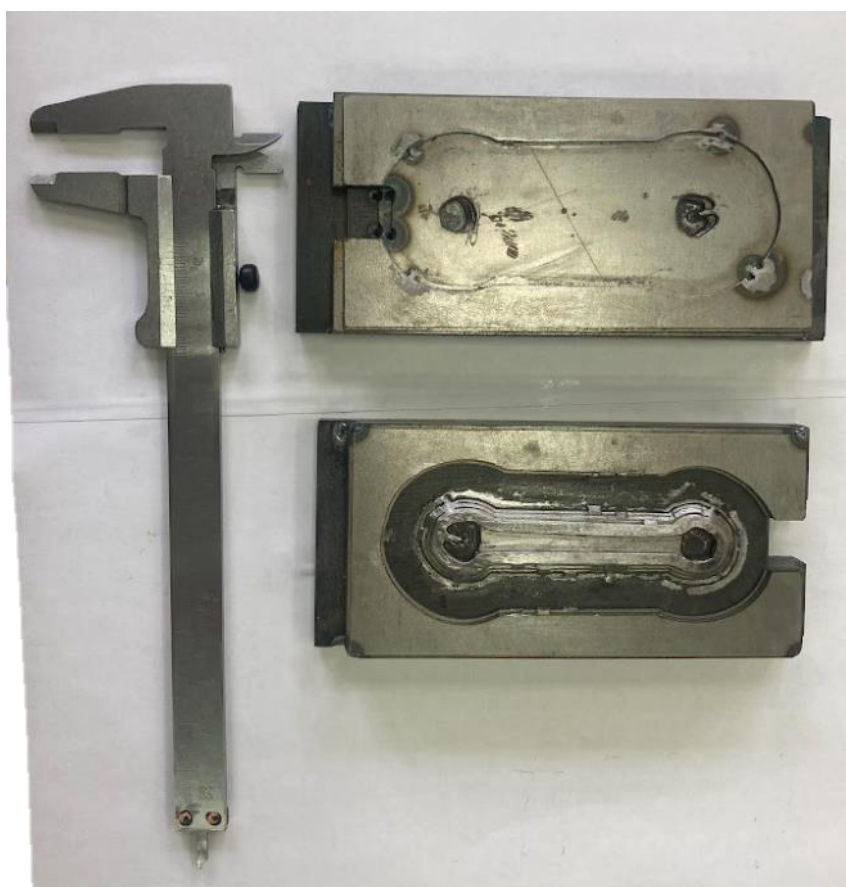
Рисунок 4.2 – Фотография верхней и нижней частей модельного штампа с облойной канавкой измененных размеров
