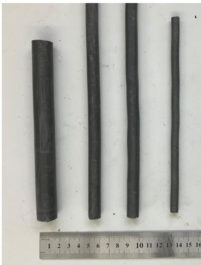
Рисунок 4.7 – Прутковые заготовки, полученные прессованием из слитка
