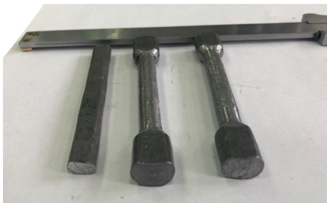
Рисунок 4.8 – Предварительно профилированные заготовки из свинца различной формы
