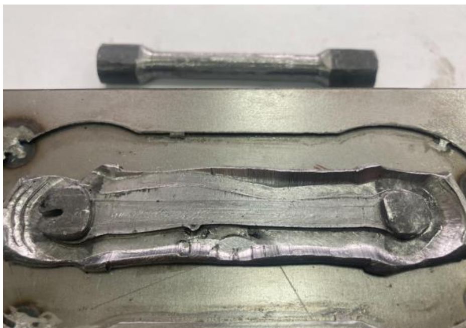
Рисунок 4.14 – Поковка с деформированной ручкой
