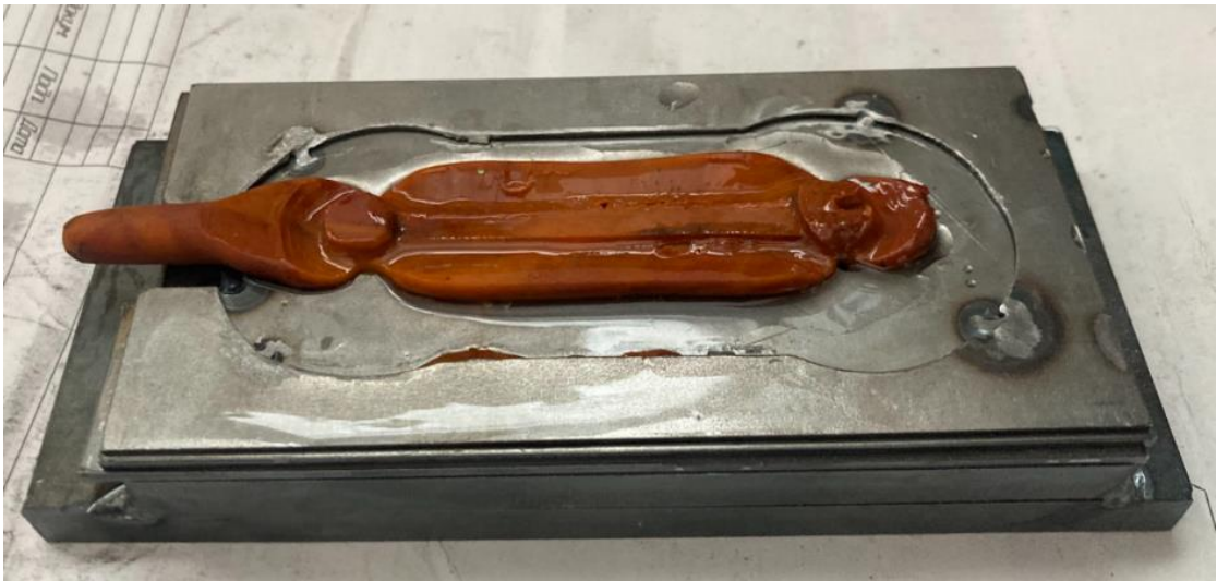
Рисунок 4.3 – Полученная «поковка» из пластилина
