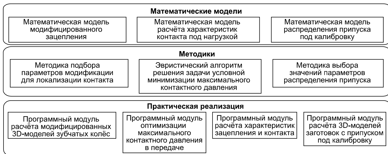
Рисунок 13 – Структура программного средства в составе АСТПП
