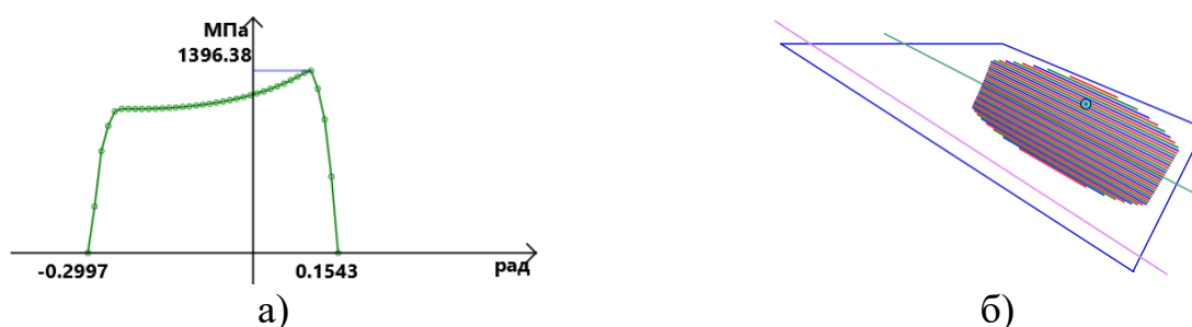
Рисунок 10 – Характеристики контакта а) зависимость максимального контактного давления от фазы зацепления б) пятно контакта
