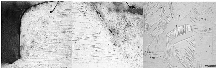
Ри. 5. Пластическая деформация при сверлении стали 1.4541
