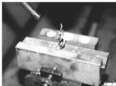
Рис. 9. Отлом сверла и его заклинивание на объекте
