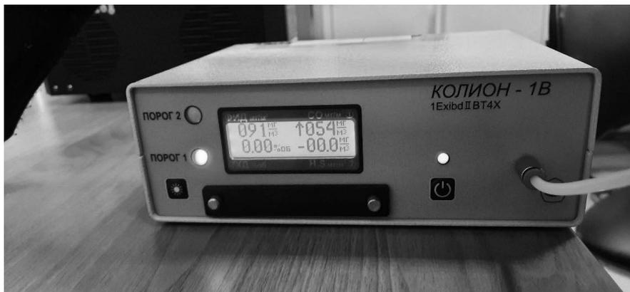
Рис. 4. Измерение ПДК газоанализатором
