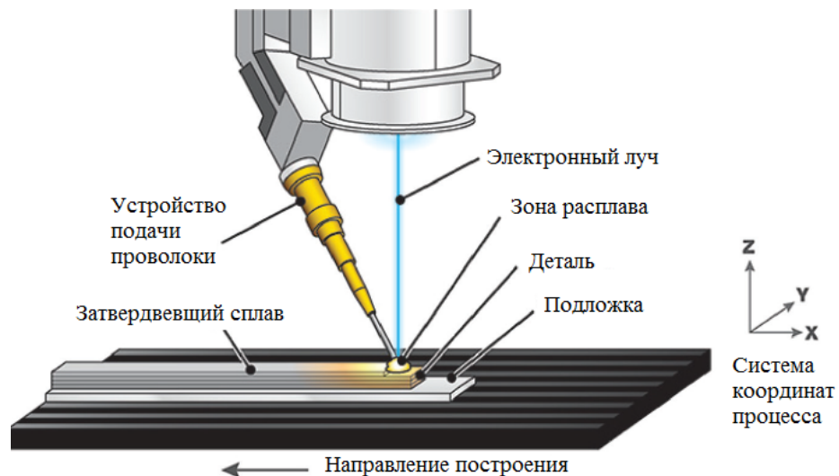
Рисунок 1.3 – Схема технологии электронно-лучевого плавления
