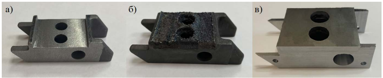
Рисунок 4.9 – Внешний вид литой заготовки (а), заготовки после наплавки (б), готовой детали (в)
