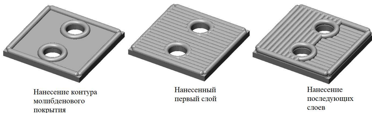
Рисунок 4.8 – Схема наплавки и стратегия сканирования
