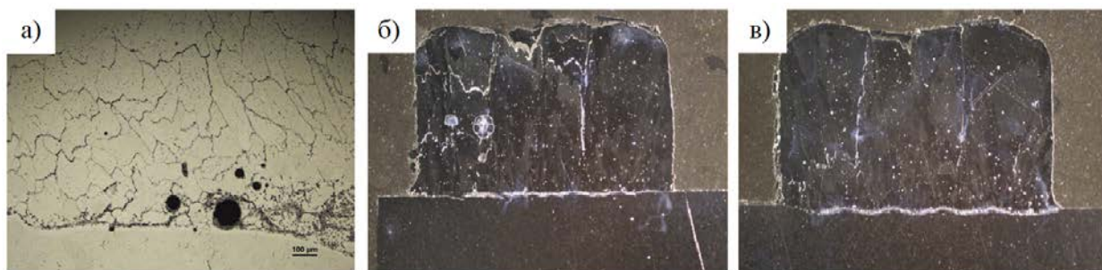
Рисунок 1.6 – Микроструктура поперечного сечения слоев, полученных при мощности лазерного излучения и скорости сканирования: 4500 Вт и 510 мм/мин (а), 7000 Вт и 635 мм/мин (б), 9000 Вт 635 мм/мин (в)
