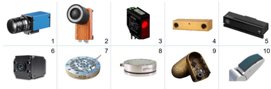
Рисунок 1.21 – Типовые датчики, применяемые в задачах роботизированного манипулирования: 1 – высокоскоростная промышленная камера; 2 – интеллектуальная промышленная камера; 3 – лазерный датчик дальности; 4 – стереокамера; 5 – датчик освещенности; 6 – камера времени полета; 7 – датчик крутящего момента в суставе; 8 – силомоментный датчик; 9 – датчик давления пальца; 10 – пальцевая тактильная матрица
