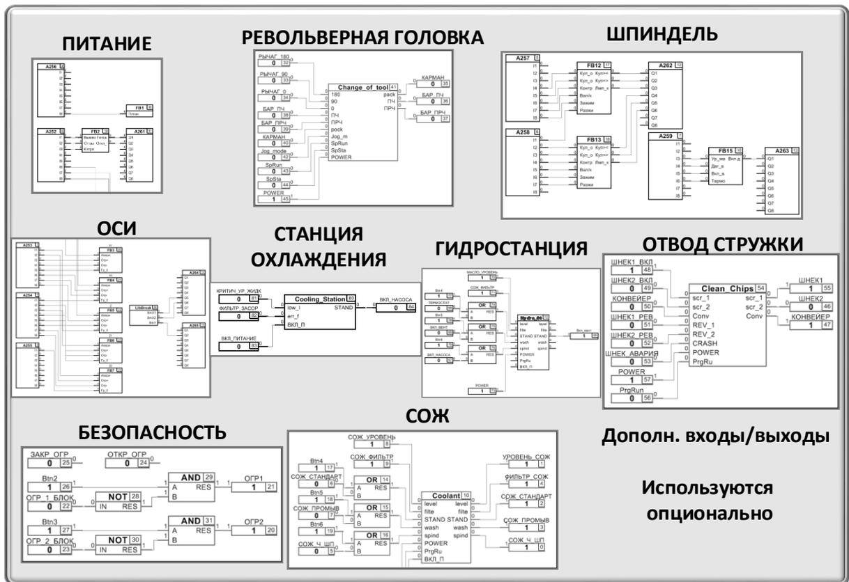
**Рисунок 4.3 – Макет испытательного стенда после выделения структуры модулей в СЛУ**
