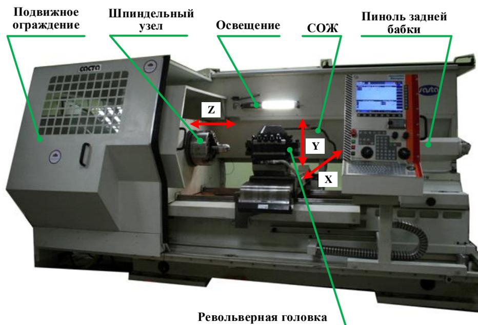
**Рисунок 4.2 – Токарный станок с ЧПУ СА-700**
