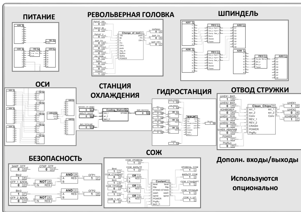
Рисунок 10 – Макет испытательного стенда после выделения структуры модулей в СЛУ
