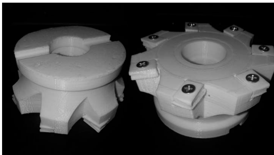
Рис. 2. Модель плунжерной фрезы с тангенциальным закреплением пластин с возможностью изменения переднего и заднего радиальных углов
