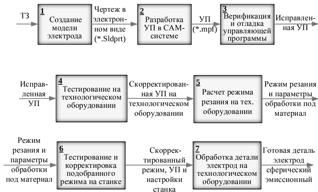
Рис. 2. Методика изготовления детали «Электрод сферический эмиссионный»
