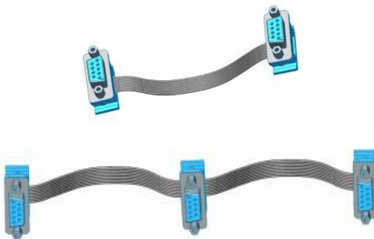
Рисунок 10 – Вид кабеля после обжимки
