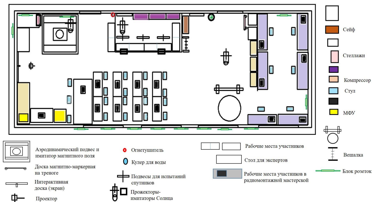
План застройки компетенции WorldSkills Russia «Инженерия космических систем» для возрастной категории 16-20 лет
