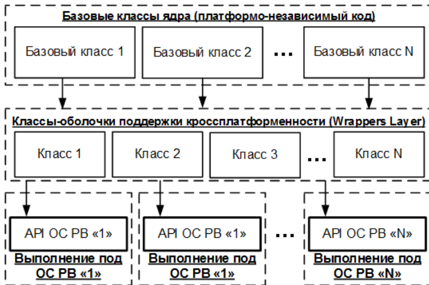
Рисунок 2.7 Структурная схема уровня программной платформы
