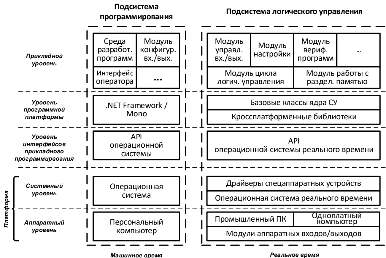
Рисунок 2.6 Модель системы логического управления по типу виртуальной машины
