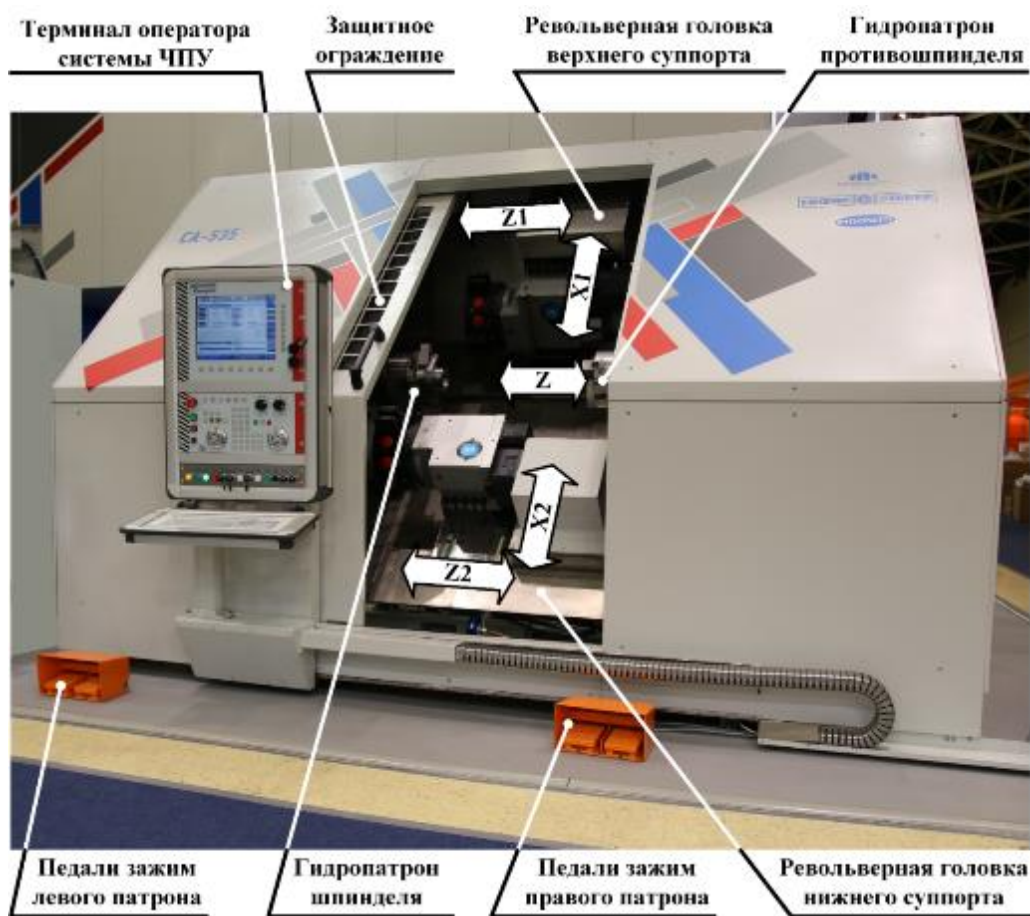
Рисунок 5.13 Обрабатывающий центр наклонной компоновки «СА 535»
