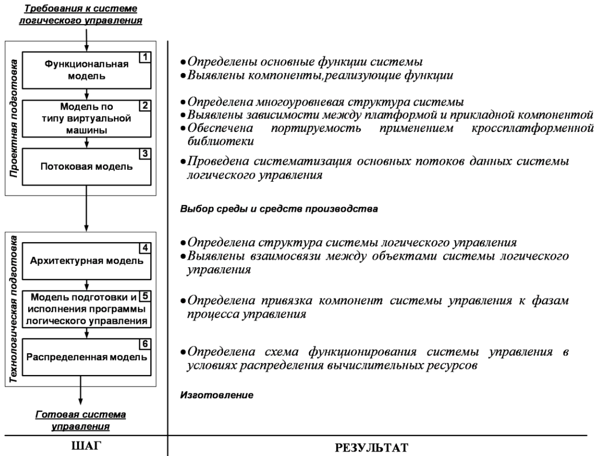
Рисунок 2.4 Схема последовательной трансформации моделей систем логического управления
