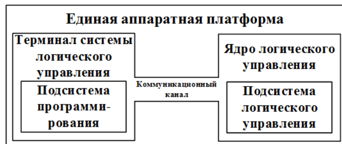
Рисунок 2.2 Схема системы логического управления на базе единой аппаратной платформы
