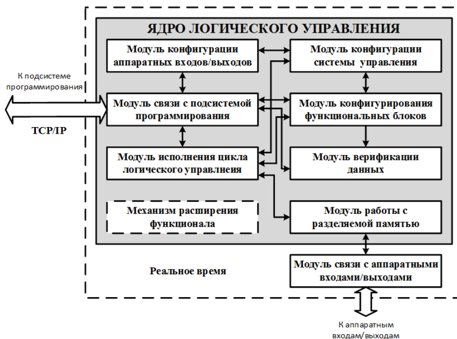
Рисунок 3.8 Модули системного ядра логического управления
