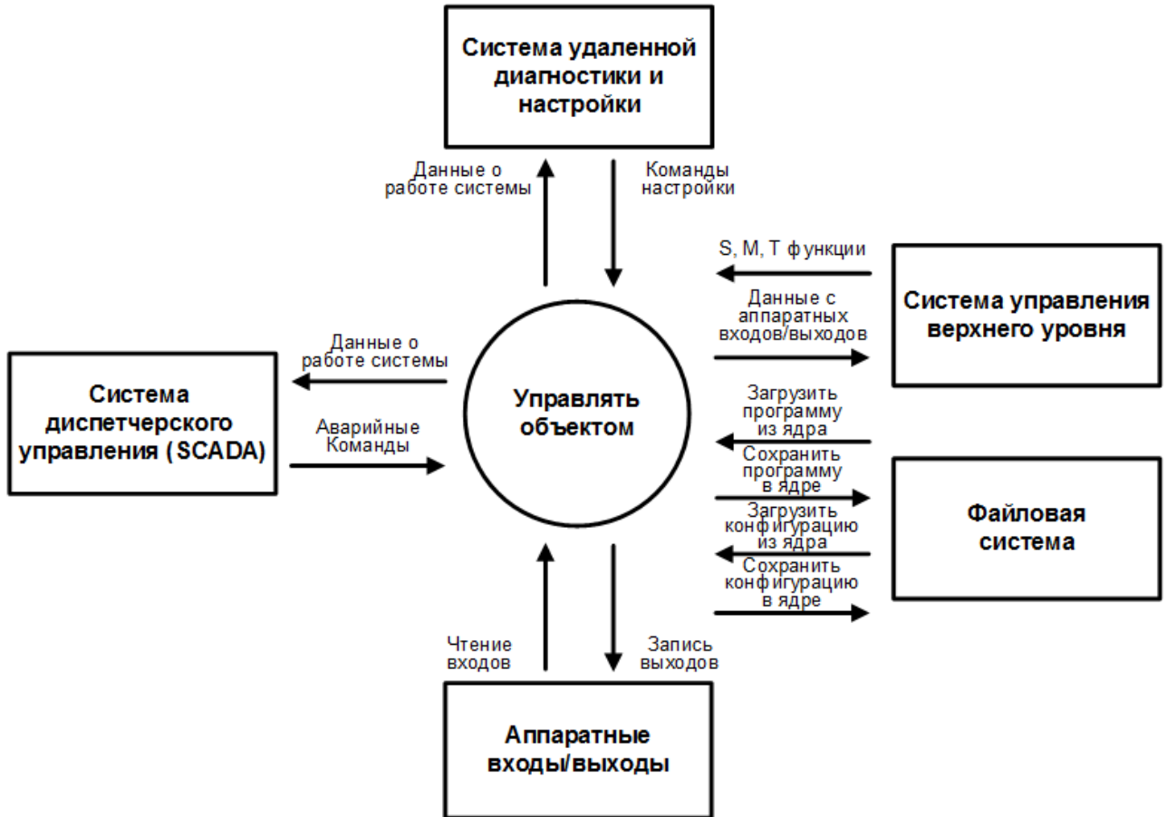
Рисунок 2.8 Исходная диаграмма потоковой модели системы логического управления
